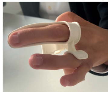
Fig. 10. Peça produzida em FFF com extensão para o dedo.
