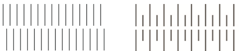
Figura E.22 e E.23- Agulhamento tipo RIB e agulhamento tipo Interlock respetivamente [20]
