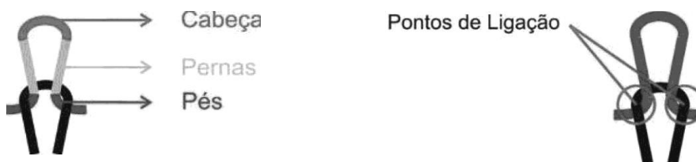
Figura E.4 e E.5- Laçada de uma malha de trama e representação de pontos de ligação respetivamente [15]
