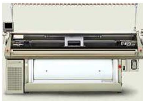
Figura E.34- Tear retilíneo - Shima Seiki [11]
