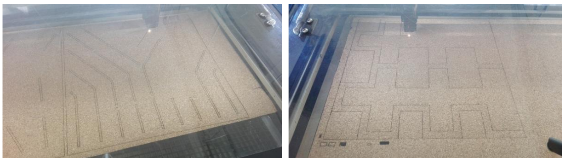
Figuras 8 e 9 - Exemplo de corte a laser, dos painéis acústicos de cortiça
