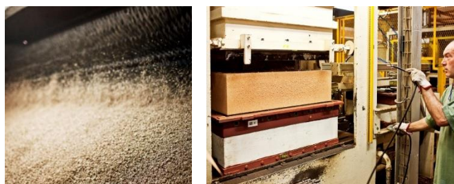
Figuras 242 e 243 - Cortiça a ser triturada; Desmoldagem do aglomerado
