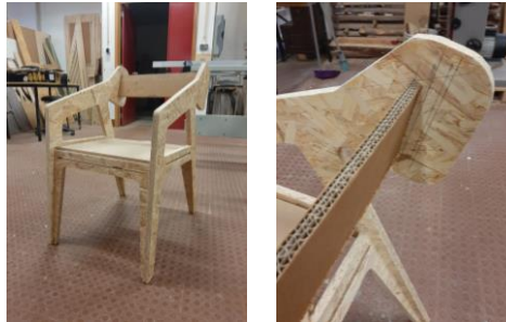
Figuras 410 e 411 - Modelo de simulação em OSB: assento provisório; estudo do encosto
