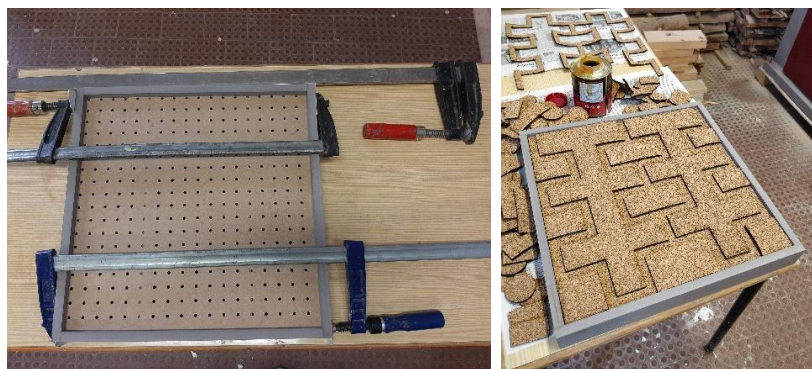
Figuras 289 e 290 - Montagem da moldura e colagem das camadas de cortiça
