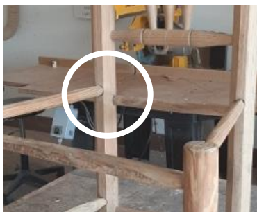
Figura 313 - Pormenor onde se mostra a posição da travessa lateral ligeiramente mais para cima do que a posterior
