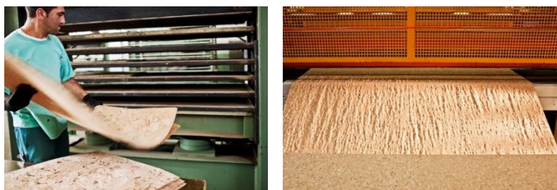
Figuras 244 e 245 - Obtenção das folhas (esquerda) e do tecido (direita) de cortiça
