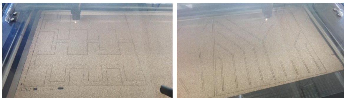
Figuras 285 e 286 - Corte a laser das camadas do Tipo A e C
