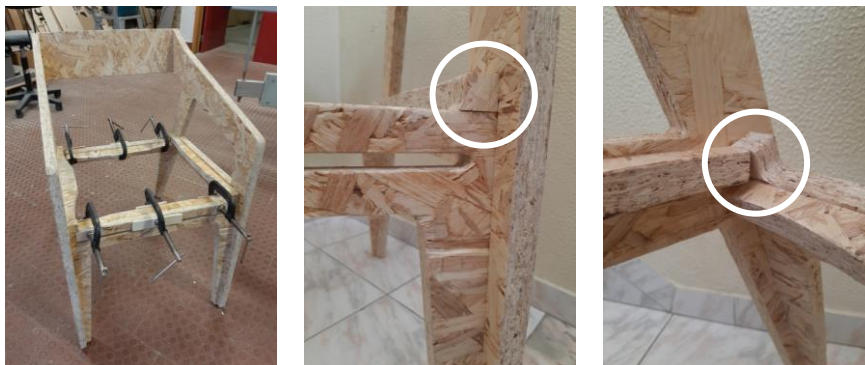
Figuras 412, 413 e 414 - Modelo de simulação em OSB: colocação dos reforços; pormenores dos acrescentos na peça frontal e posterior
