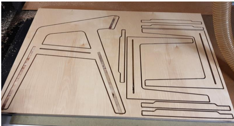
Figuras 434 e 435 - Peças do protótipo cortadas em CNC; colagem da estrutura
