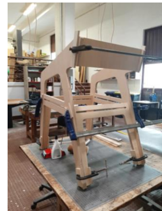
Figuras 434 e 435 - Peças do protótipo cortadas em CNC; colagem da estrutura
