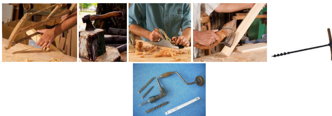
Figuras 307, 308, 309, 310, 311 e 312 66 - Utensílios para cortar e falquejar a madeira: serra, machado, cepilho (plaina), enxó, trado e arco de pua
