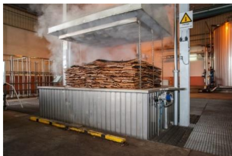
Figura 239 - Cozedura das pranchas de cortiça
