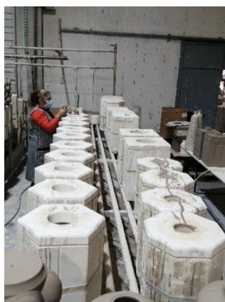
Figura 40- Enchimento dos moldes; Fonte: Mariana Vieira.
