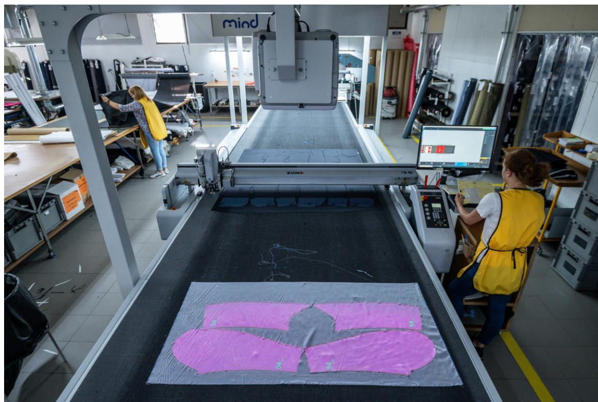
Figura 13 - Máquina de corte automático de tecido xadrez da Confeções Lança, Lda. (Fonte: Confeções Lança, Lda., 2023).
