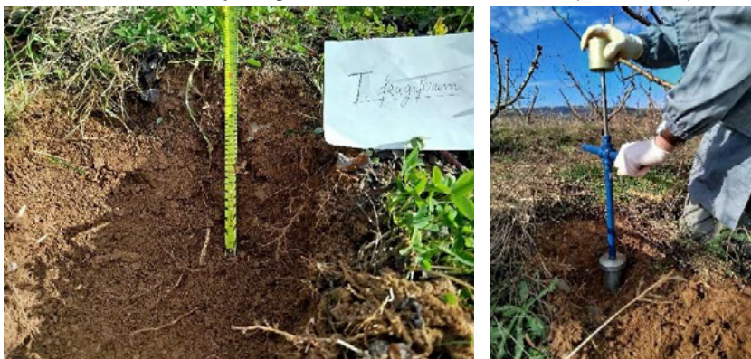
Figura 4.9 – Colheita de amostras de terra para a determinação da densidade aparente.
