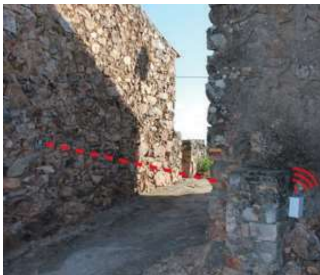
Local de testes, em Penha Garcia, com sensor ótico e módulo de comunicações 3G (caixa branca).
