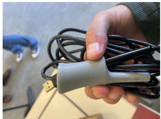
Figura 2 - LipCam (bocal com cabo USB) Fonte: Câmara telemóvel
