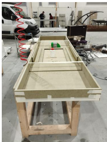
Figura 36 - Montagem da caixa da base - Fundação Inatel (Fonte: Autora,2023)
