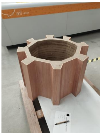
Figura 41 - Peça revestida com HPL - Fundação Inatel (Fonte: Autora,2024)
