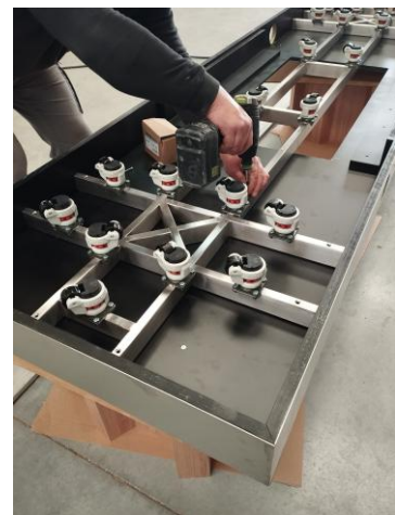
Figura 38 - Montagem dos Rodízios - Fundação Inatel (Fonte: Autora,2023)
