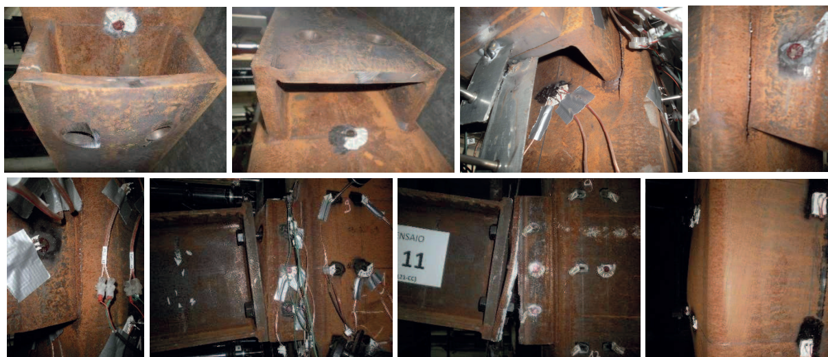
Fig. 8: Deformações plásticas nos elementos
