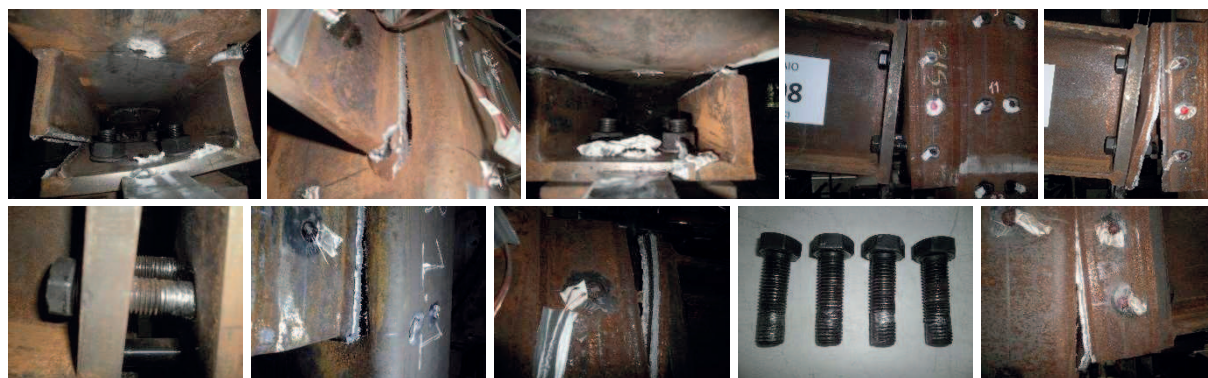
Fig. 9: Modos de rotura
