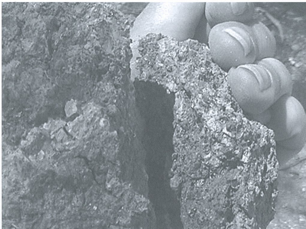
Figura 23 – Rocha alterada: “granito podre”
