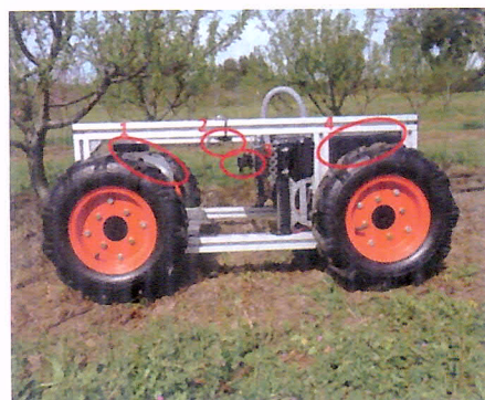
FIGURA 7. Rover Robótico de Aplicações Agrícolas. Legenda: 1) Reservatório de herbicida. 2) Sistema de visão computacional. 3) Manipulador robótico cartesiano com bico pulverizador. 4) Sistema de controle.
