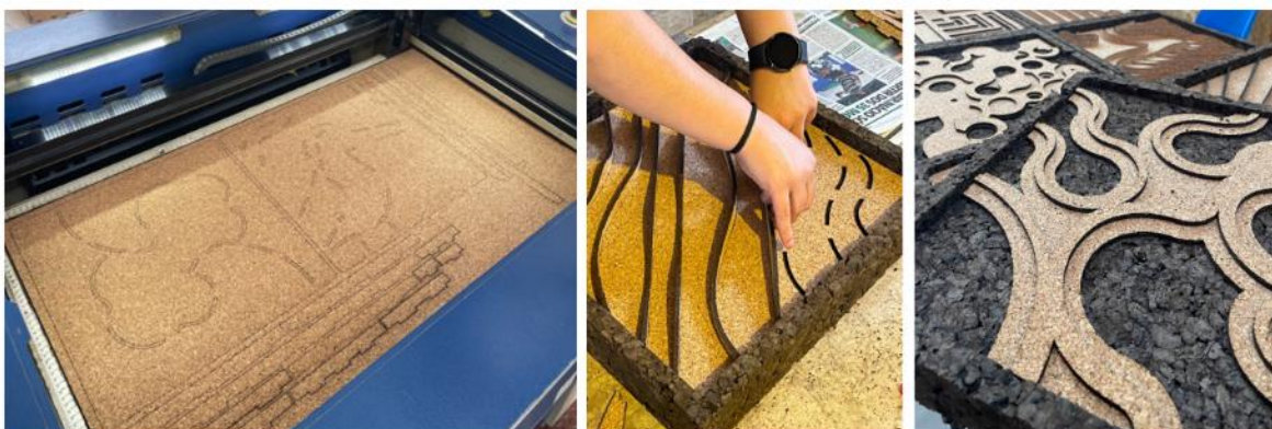
Figura 72 - Corte a laser e colagem dos protótipos tipo A e C. Fotografias da Autora, 2024.
