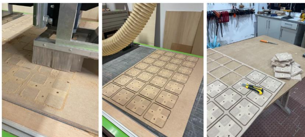
Figura 106 - Maquinação das peças de encaixe ao painel. Fotografias da Autora, 2024
