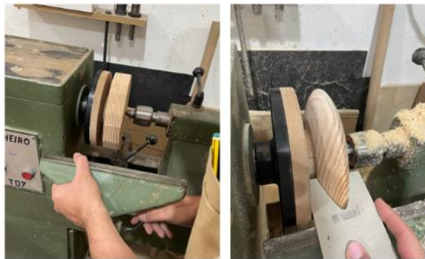
Figura 44 – Colocação do prato de metal no torno. Verificação do formato da peça através de um molde. Fotografia da Autora, 2023
