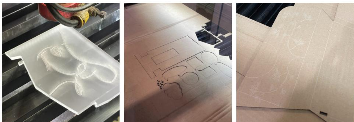
Figura 64 - Provete de testes, em acrílico, e corte de maquetas à escala real, em cartão canelado. Fotografias da Autora, 2024
