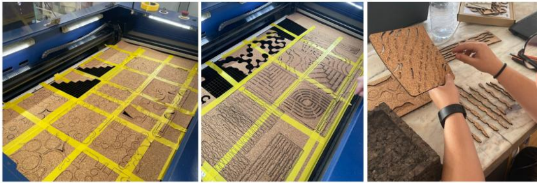
Figura 70 - Corte a laser dos modelos à escala dos painéis, tipo A e C. Fotografias da Autora, 2024
