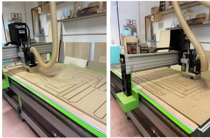
Figura 77 - Fresagem de protótipos à escala real. Fotografias da Autora, 2024.
