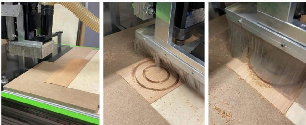
Figura 49 - Maquinação do protótipo final à escala 1:1. Fotografia da autora, 2023
