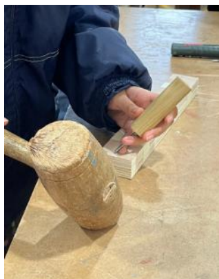
Figura 53 - Picagem das furações. Fotografia da autora, 2024
