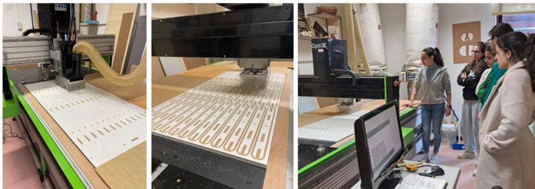
Figura 59 - Maquinação das navetes em placa de MDF laminado a branco, de 3mm. Fotografia da Autora, 2024
