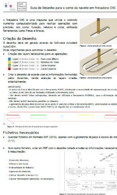
Figura 91 - Guia de Desenho para o corte da navete em fresadora CNC. Fonte: Autora, 2024.
