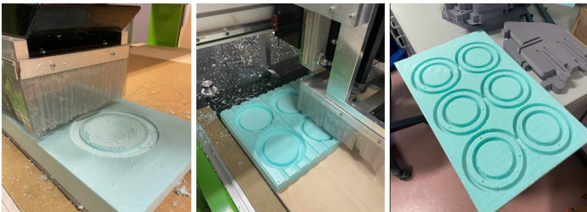
Figura 48 - Maquinação das maquetas à escala 1:1, em poliestireno. Fotografia da Autora, 2023
