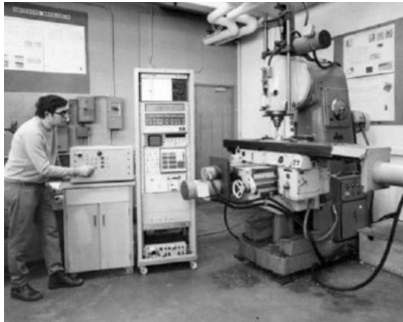
Figura 4 - Fresadora NC de John Parsons (Ye, 2023)
