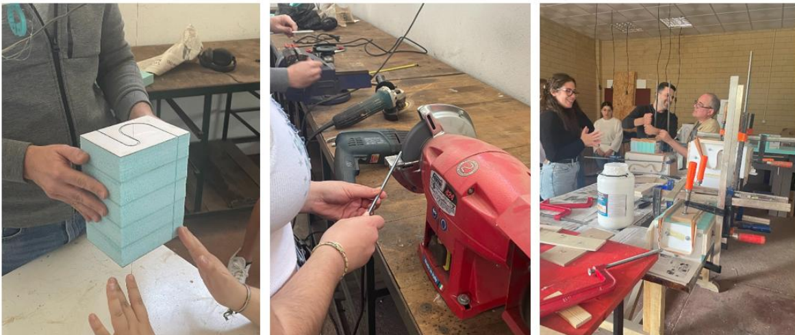
Figura 62 – Corte do molde em fio quente; Utilização do esmeril para dar acabamento às pontas do varão roscado; processo de moldagem. Fotografias da Autora, 2024
