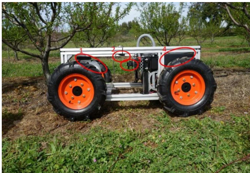
Figura 10 – Rover Robótico de Aplicações Agrícolas. Legenda: 1) Reservatório de herbicida. 2) Sistema de visão computacional. 3) Manipulador robótico cartesiano com bico pulverizador. 4) Sistema de controlo.
