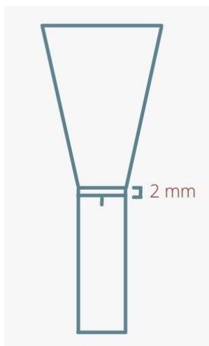
Figura 33 - Colocação do 1º arame
