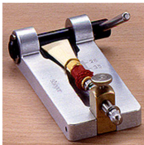
Figura 45 - Exemplo de abrir a ponta com o uso da guilhotina
