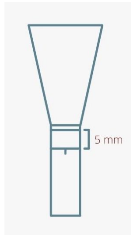
Figura 35 - Colocação do 2º arame
