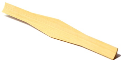
Figura 29 - Exemplo de cana goivada, raspada e formada
