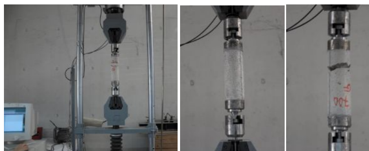
Figura 2: Sistema de ensaio – resistência à tração direta
