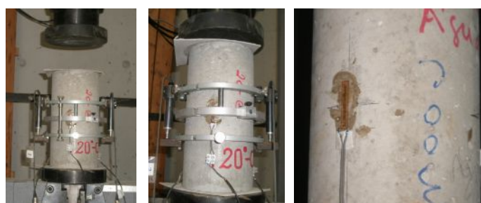
Figura 5: Sistema de ensaio – módulo de elasticidade.
