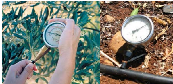
Figura 29 – Aspecto da medida da pressão do escoamento com um manómetro, num tubo de inserção de um gotejador (Junta de Andalucía, 2010), e directamente num lateral de rega (COTR, 2009).
