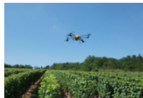
Figura 41 – Drone sobrevoando uma área de vinha para obtenção de imagens que auxiliem o manejo da cultura, nomeadamente a operação da rega.
