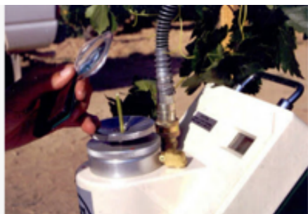
Figura 33 – Câmara de pressão em utilização, destacando-se a observação com uma lupa da exsudação de água no pecíolo de uma folha.
