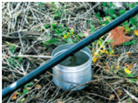
Figura 28 – Aspecto da recolha de água num copo, para avaliação do caudal de um gotejador (COTR, s/d).
