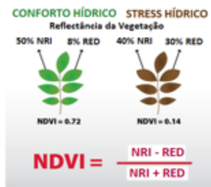
Figura 40 – Esquema que exemplifica a forma como é calculado o índice NDVI (NRI – Near Infra-Red – banda do infravermelho próximo; RED – banda do vermelho).
