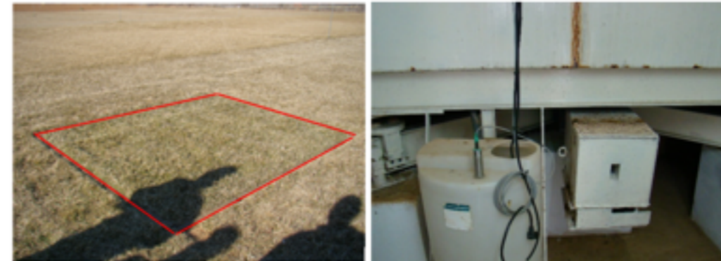
Figura 7 – Aspecto de um lisímetro para avaliação da evapotranspiração de referência (ET o ) revestido com relva (cultura de referência), e espaço subterrâneo com destaque para a balança de precisão.
