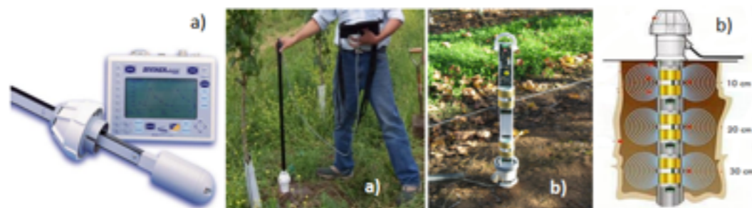
Figura 37 – Sondas FDR com os respectivos tubos de acesso, sonda DIVINER (a) e sonda ENVIROSCAN (b).
