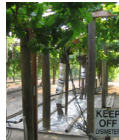
Figura 10 – Aspeto de um lisímetro para avaliação da evapotranspiração da cultura da vinha.
