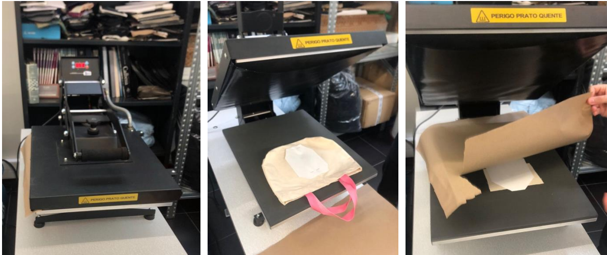
Figura 120 – Processo de impressão por sublimação. Fonte: Autora.
