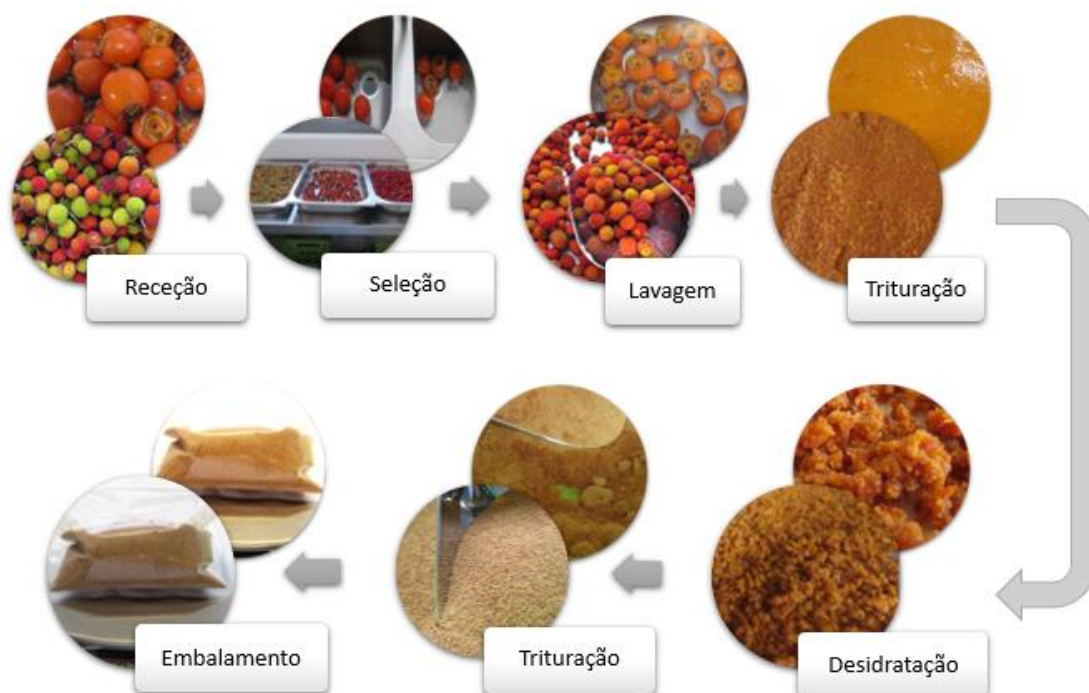
Figura 3.1. Processo de obtenção de fruta em pó a partir de medronho e dióspiro.
