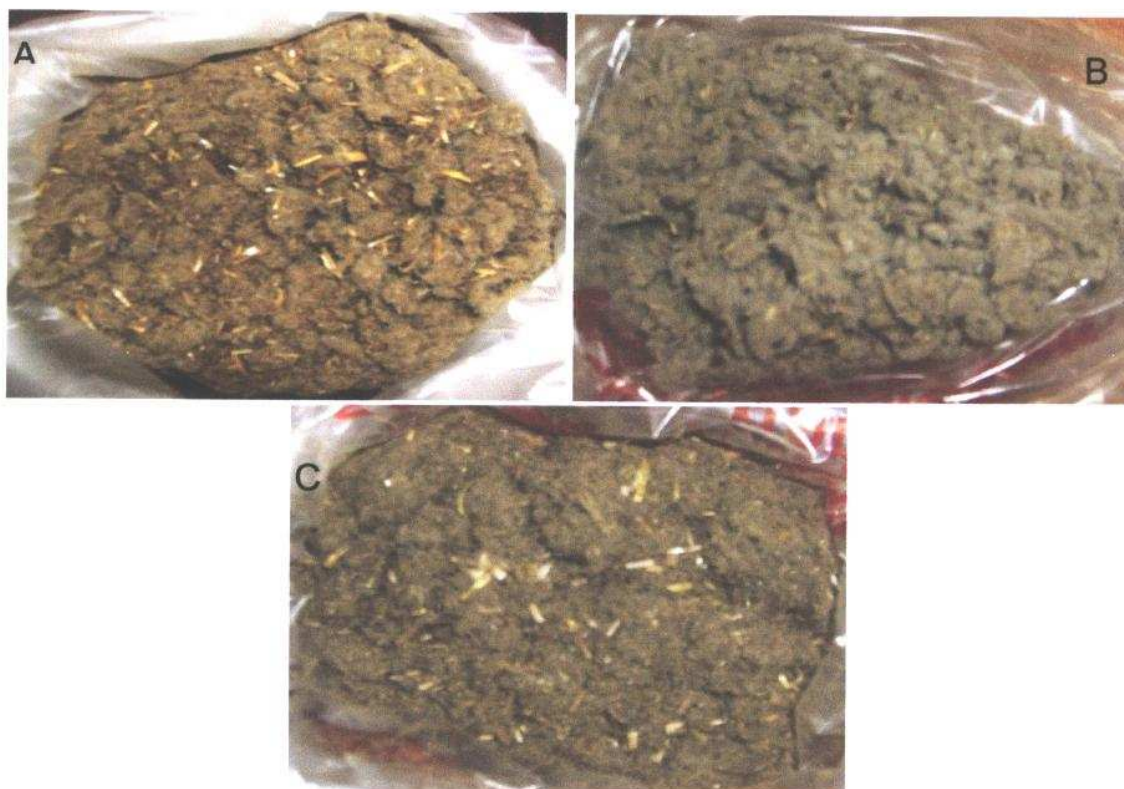
Figura 4.6. Resíduos FTNP produzidos na operação de abertura mecânica da lavada no abridor de lã lavada (A). Resíduos separados após crivagem, FTNP' (B) e RO (C).
