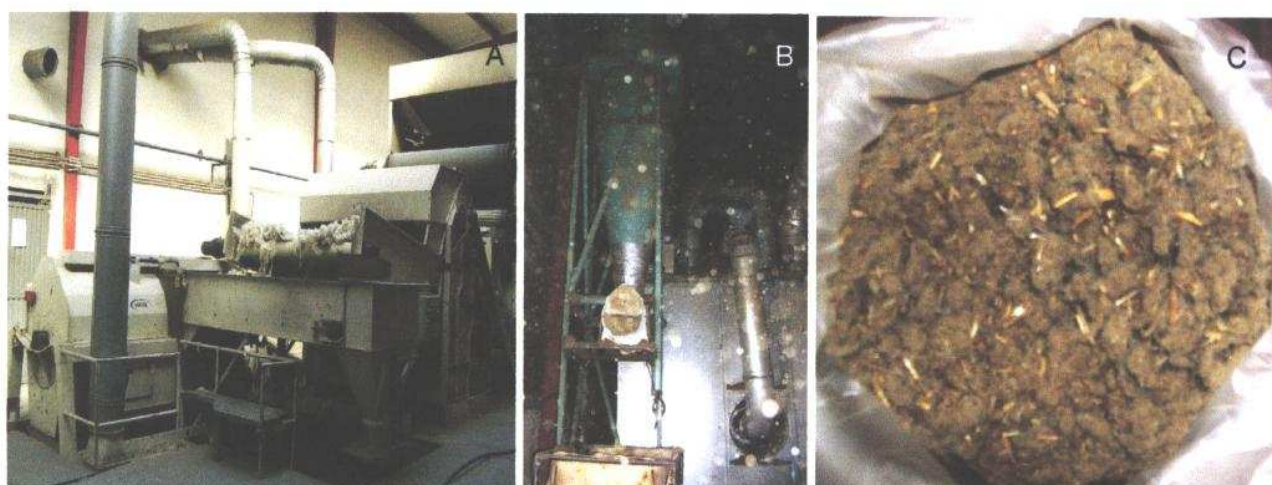
Figura 3.8. Abridor de lã lavada (A). Recolha de resíduos separados no abridor (B). Pormenor dos resíduos FTNP e RO separados no abridor de lã lavada (C).
