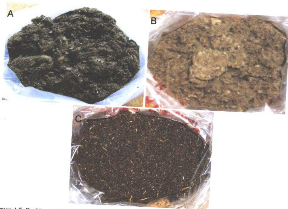
Figura 4.5. Resíduos de FTNP produzidos na operação de abertura mecânica da lã suja recolhidos no abridor de lã suja (A). Resíduos separados após crivagem, FTNP' (B) e RO (C).
