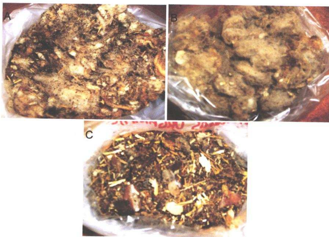
Figura 4.4. Resíduos de FTNP produzidos na operação de abertura mecânica da lã suja recolhidos no carregador de lã suja (A). Resíduos separados após crivagem, FTNP' (B) e RO (C).
