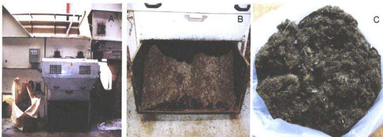
Figura 3.7. Abridor de lã suja (A). Recolha de resíduos separados no abridor (B). Pormenor dos resíduos FTNP e RO separados no abridor de lã suja (C).
