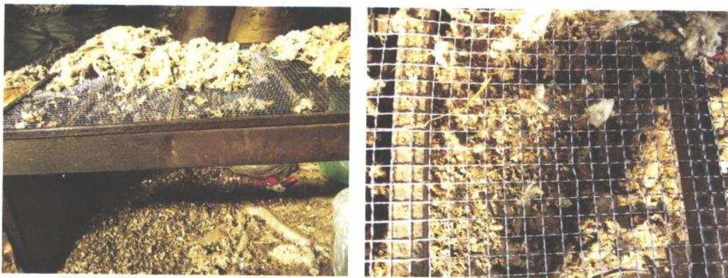
Figura 2.2. Mesa com tampo de malha metálica de 3 cm utilizada na escolha da lã.
