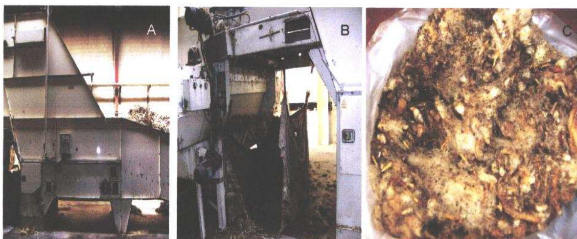
Figura 3.6. Carregador de lã suja (A). Recolha de resíduos separados no carregador (B). Pormenor dos resíduos FTNP e RO separados no carregador (C).
