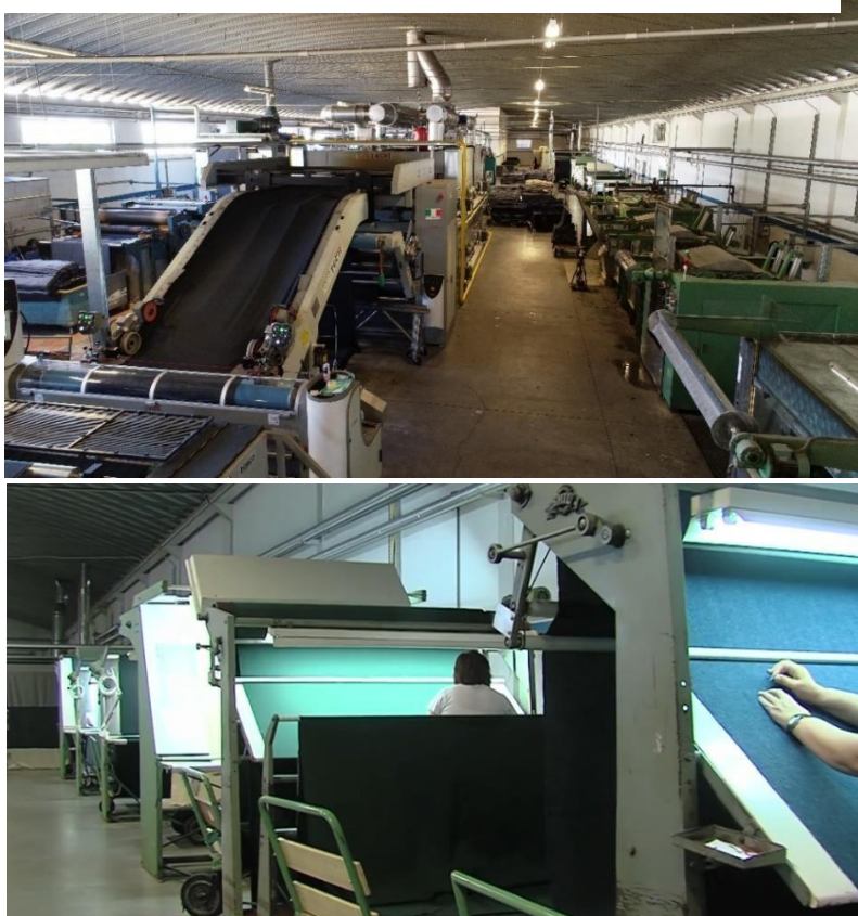
Figura 50 - Unidades de Ultimação (em cima) de inspeção/controlo de qualidade (em baixo). Fonte: Fitecom
