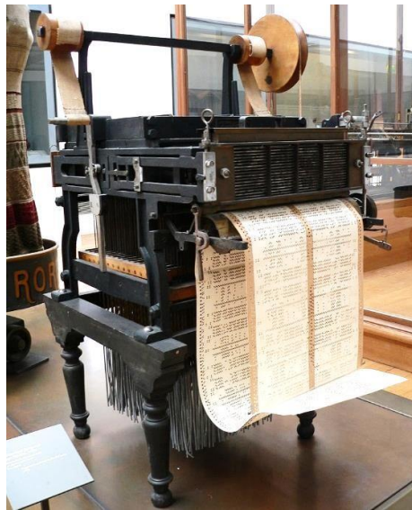
Figura 5 - Tear automático, Mecanismo Jacquard no “Musée des arts et métier”. Fonte: https://upload.wikimedia.org/wikipedia/commons/thumb/b/b6/Jacquard_loom_p1040320.jpg/800px-Jacquard_loom_p1040320.jpg
