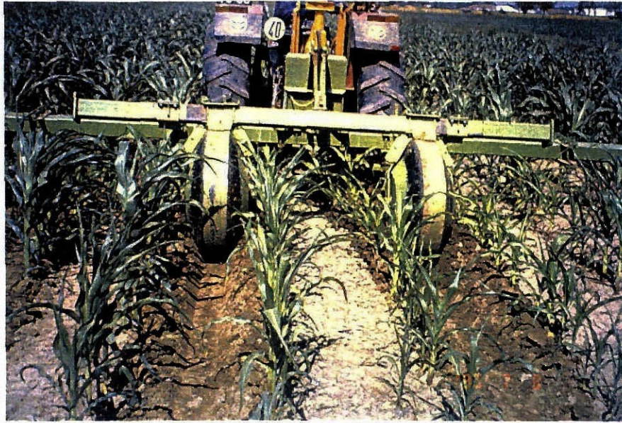
Foto 3.1 - Abre-sulcos com rodas compactadoras, utilizado na operação de abertura dos sulcos.
