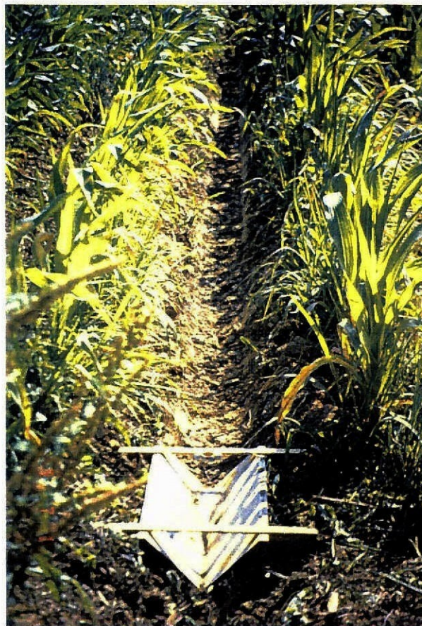
Foto 3.4 - Medidores portáteis de soleira espessa modificada para avaliação dos caudais nos sulcos.
