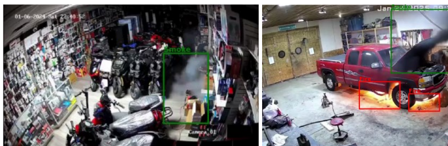
Figura 5: Exemplos de deteção do sistema FireView.
