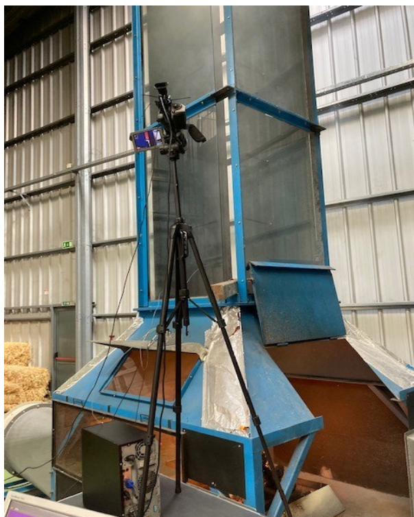
Figura 8: Visão geral do teste com a câmara infravermelha.
