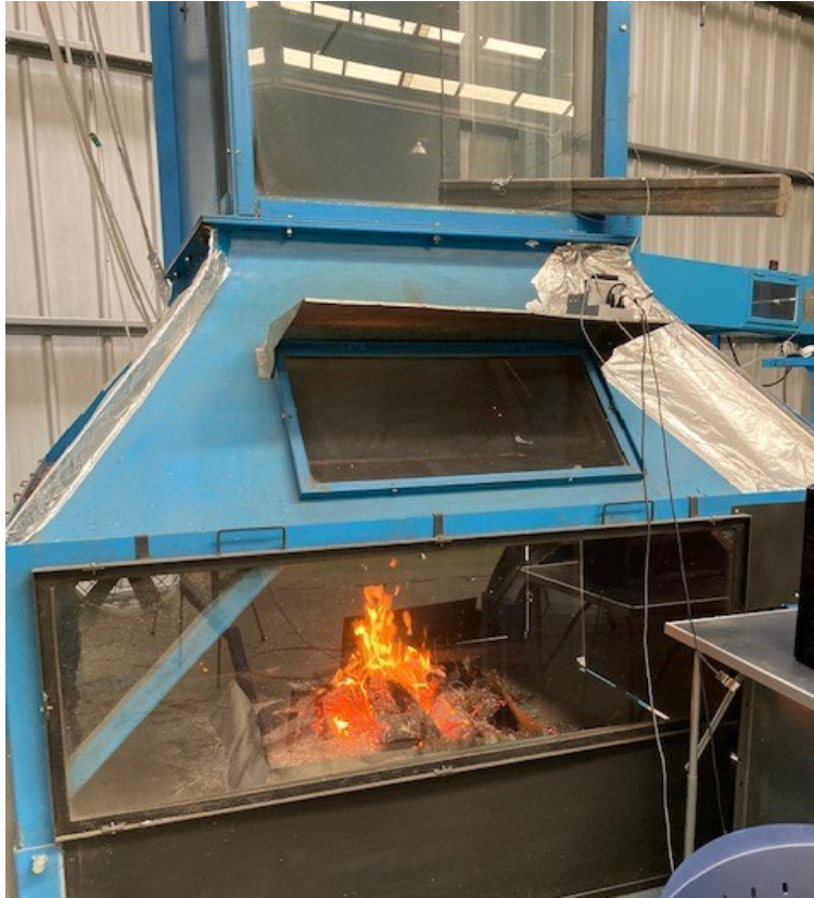
Figura 7: Túnel de combustão vertical, com viga de madeira durante o teste.
