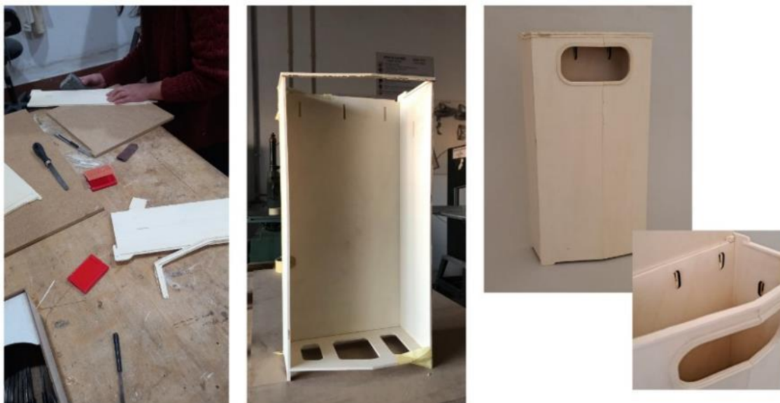
Figura 239 - Acabamento, montagem de modelo 1:2 em contraplacado. Fotografias da Autora, 2023.
