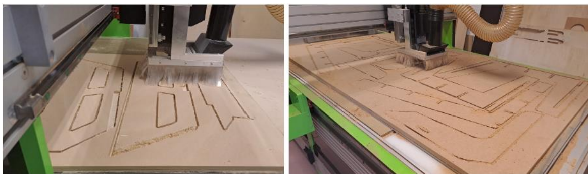
Figura 119 - Fresagem de protótipos à escala real. Fotografias da Autora, 2023.
