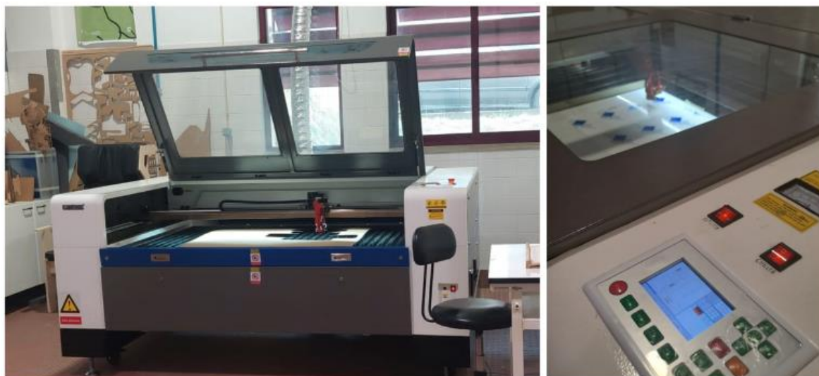
Figura 45 - Máquina de corte laser CO2 do Laboratório de Corte a Laser da ESARTPROJECTFACTORY. Fotografia da Autora, 2022.
