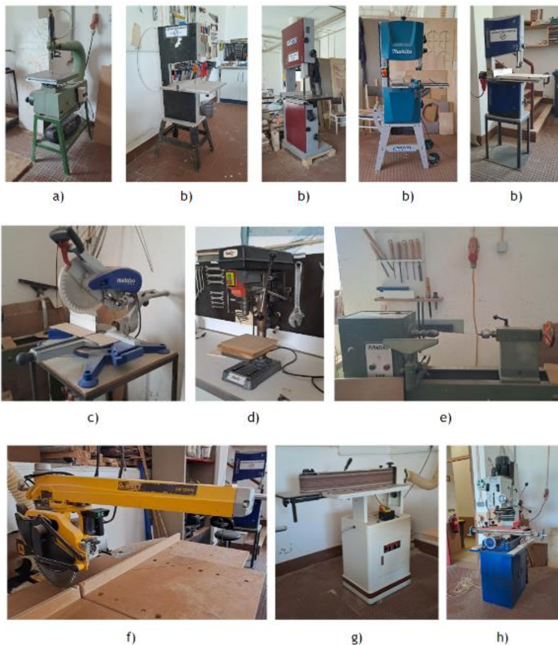
Figura 70 - Máquinas fixas e semi-fixas da oficina de madeiras | a) Serra de recortes pendular; b) Serras de fita; c) Serra de esquadria; d) Engenho de furar; e) Torno; f) Serra de braço radial; g) Lixadora de cinta; h) Fresadora manual. Fotografias da Autora, 2023.
