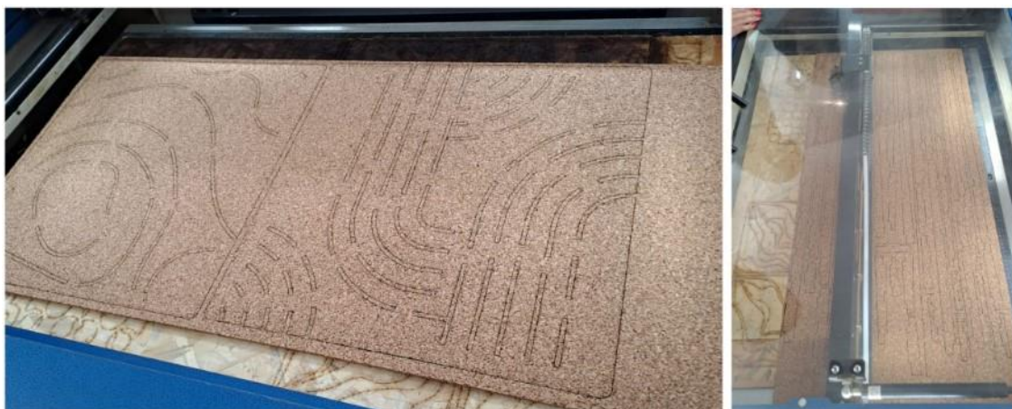
Figura 133 - Corte laser de protótipo de painel tipo C. Fotografias da Autora, 2023.
