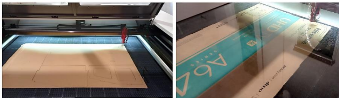
Figura 225 - Corte laser de modelo em cartão à escala do real. Fotografias da Autora, 2023.
