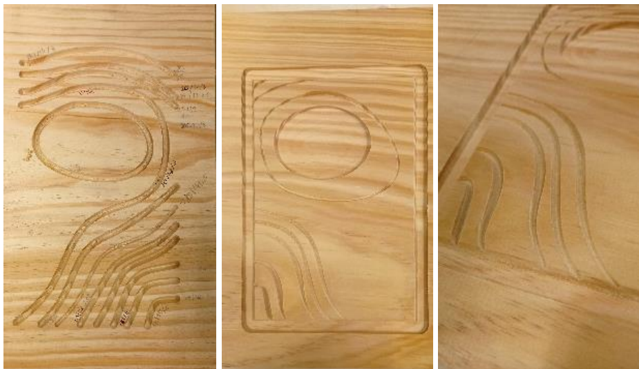
Figura 304 - Testes através da tecnologia digital fresagem CNC. Fotografias da Autora, 2022.
