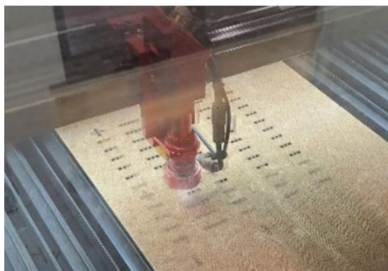
Figura 254 - Corte laser de modelos à escala em platex. Fotografia da Autora, 2023.
