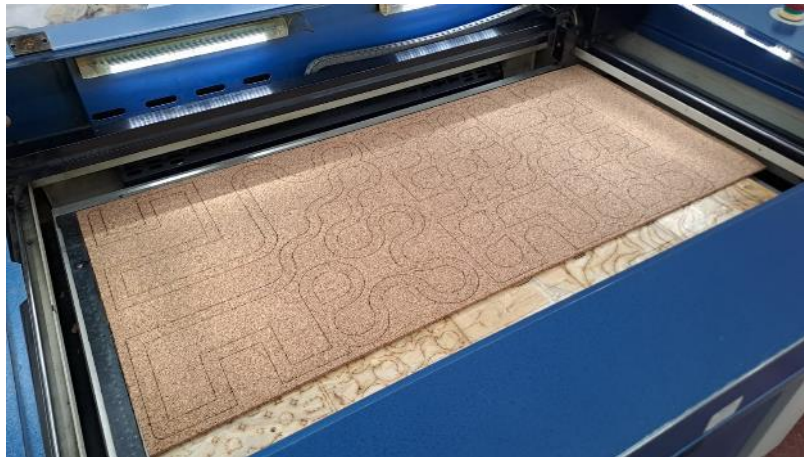
Figura 132 - Corte laser de protótipo de painel tipo A. Fotografia da Autora, 2023.
