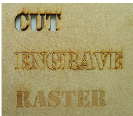
Figura 39 - Operações do sistema de produção laser (Laser Cutting Sheffield, n.d.).
