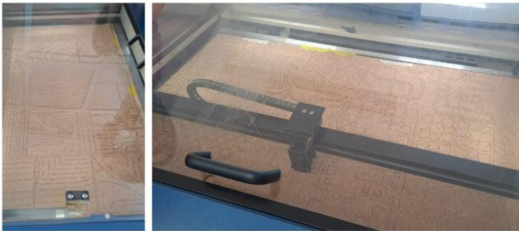
Figura 126 - Corte laser de modelos à escala dos painéis tipo A e C. Fotografias da Autora, 2023.
