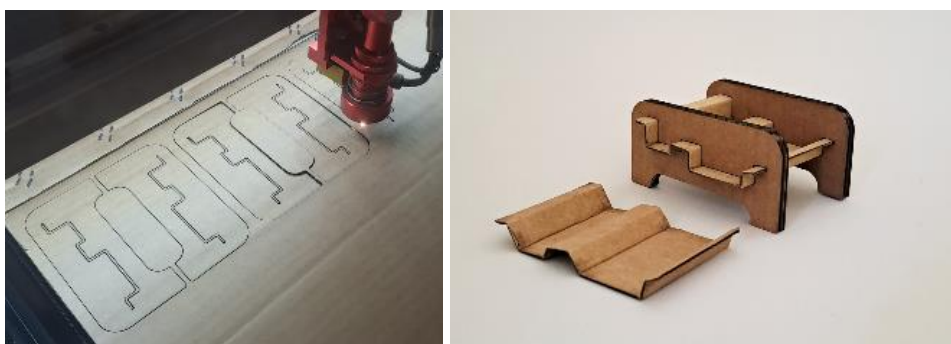
Figura 90 - Corte laser e Protótipo de despeja-bolsos. Fotografias da Autora, 2023.
