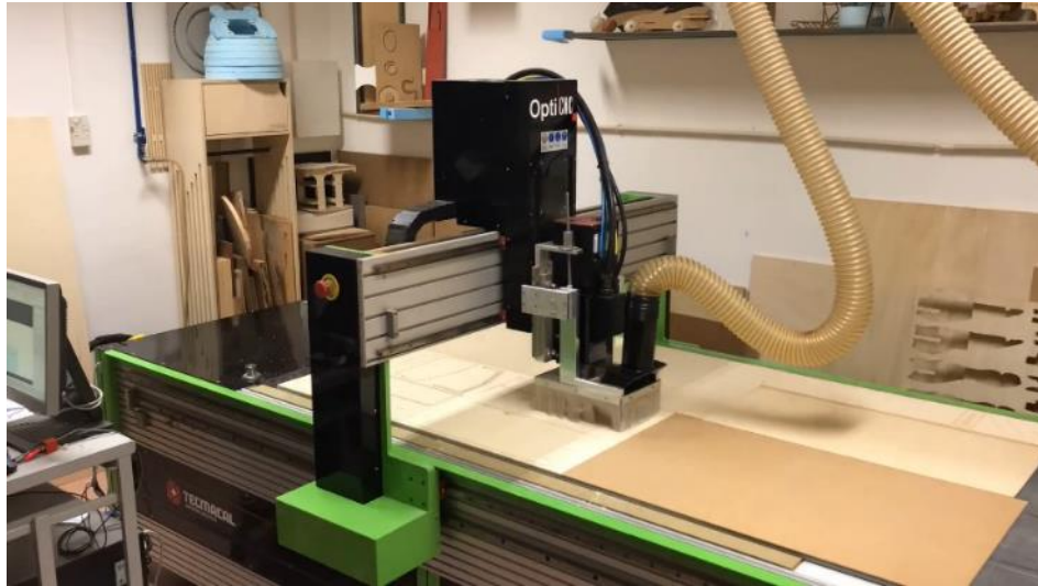
Figura 238 - Maquinação de modelo 1:2 em contraplacado. Fotografia da Autora, 2023.
