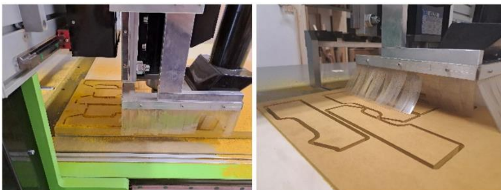
Figura 184 - Maquinação em Fresagem CNC de corpo de troféus. Fotografias da Autora, 2023.
