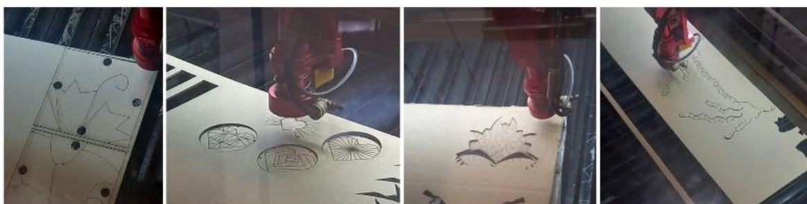
Figura 109 - Corte laser de modelos em cartão à escala do real ou 1:2. Fotografias da Autora, 2023.
