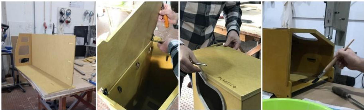
Figura 243 - Montagem e acabamento de protótipo. Fotografias da Autora, 2023.
