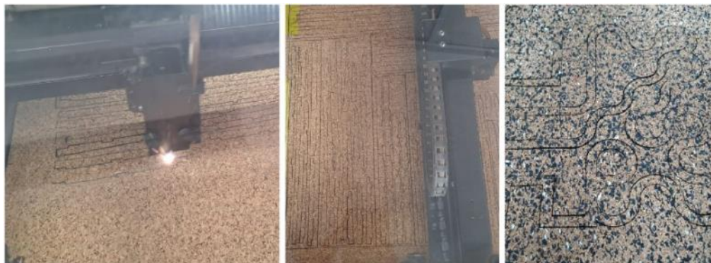
Figura 127 - Corte laser de modelos à escala dos painéis tipo A e C. Fotografias da Autora, 2023.
