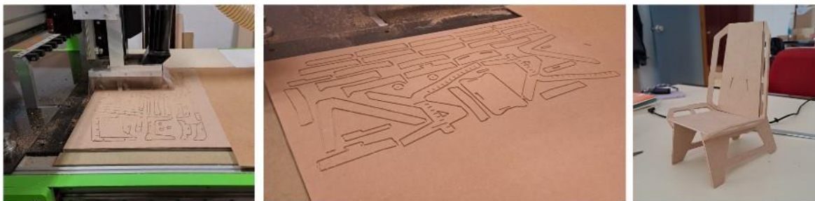
Figura 118 - Fresagem de maquetes à escala do material. Fotografias da Autora, 2023.
