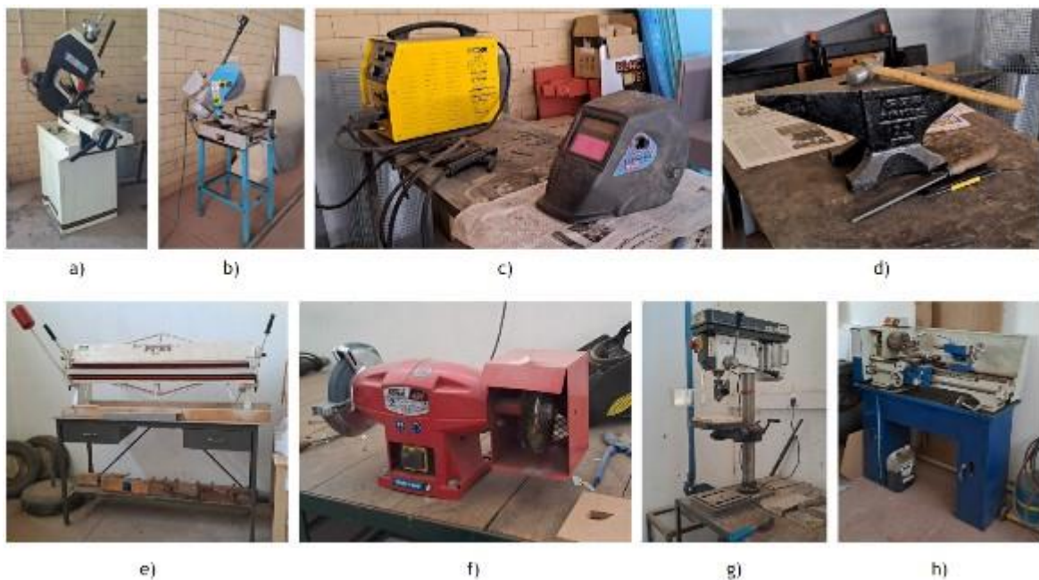
Figura 72 - Máquinas da oficina de metais | a) Serra de fita; b) Serras de disco; c) Máquina de soldar; d) Bigorna; e) Quinadora; f) Esmeril; g) Engenho de furar; h) Torno. Fotografias da Autora, 2023.
