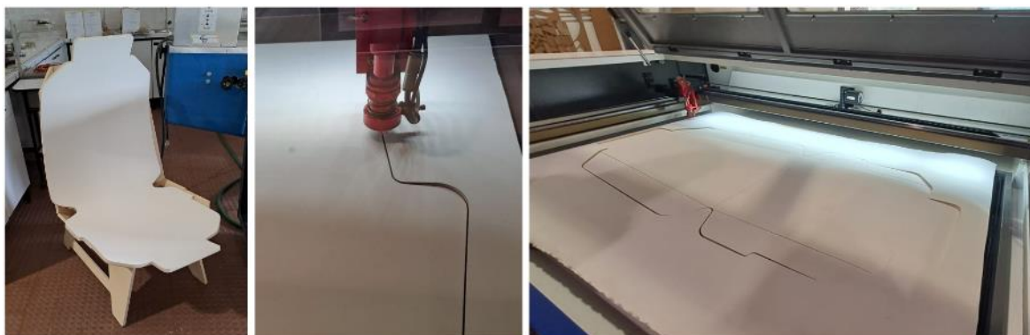
Figura 120 - Corte laser de espuma vinílica acetinada. Fotografias da Autora, 2023.
