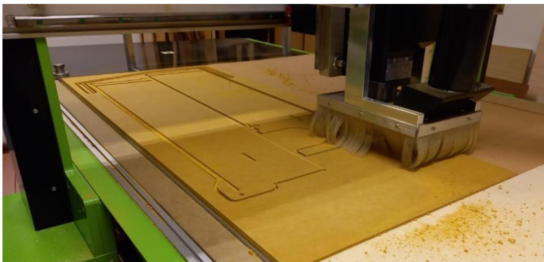
Figura 241 - Fresagem CNC de protótipo de contentor. Fotografia da Autora, 2023.
