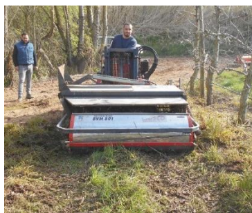
Figura 14 – Remoção de subprodutos com máquina automotriz de recolha azeitona do solo
