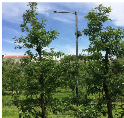
Figura 8 – Sistema remoto de monitorização da distribuição de radiação no coberto vegetal.
