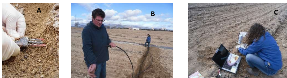
Figura 3.3.2 – Colocação do datalogger , A - colocação do sensor a 5 cm de profundidade; B- Passagem dos fios em tubo de plástico atravessando a entrelinha; C- recolha de dados no campo.
