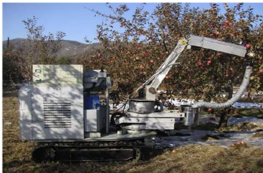
Figura 2.2 – Ensaios de campo de um sistema autónomo de colheita de frutos baseado num manipulador robótico (De-An et al. , 2011).
