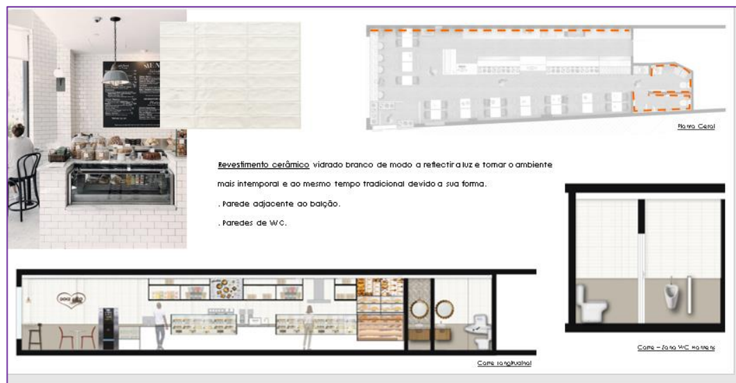
Figura 117 - Revestimento de paredes final_ Confeitaria Doce Alto - 4 Caminhos. Fonte: Autora.
