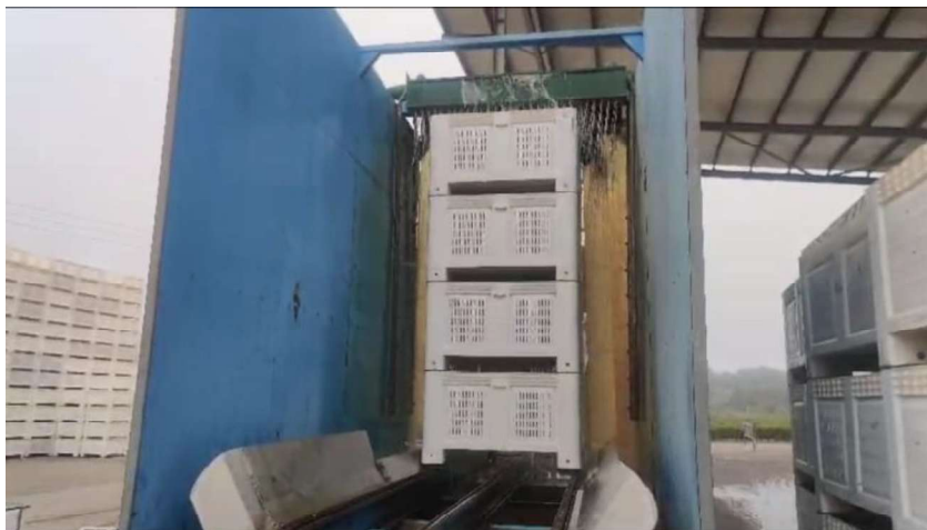
Figura 2 - Drencher em funcionamento.
