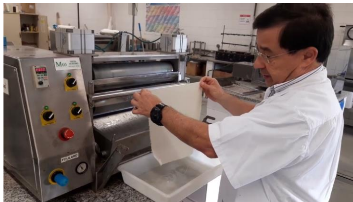
Figura 20 - Fotografia ilustrativa do processo de Foulardagem de um tecido impregnado. Fonte: João Batista Giordano, 2022.
