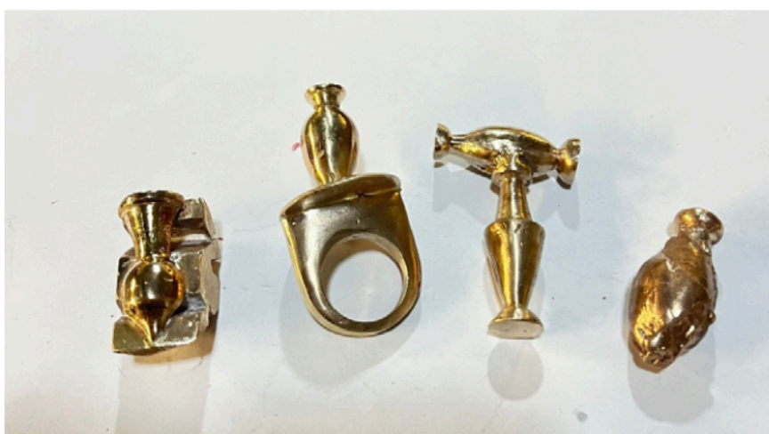
Fig. 11 Modelos de latão após serem cortados da fundição de metal da árvore.
