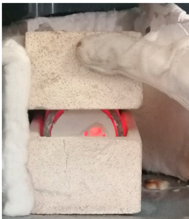
Fig. 4 Mufla MW, incandescência no processo de cozedura de molde refractário por micro-ondas.
