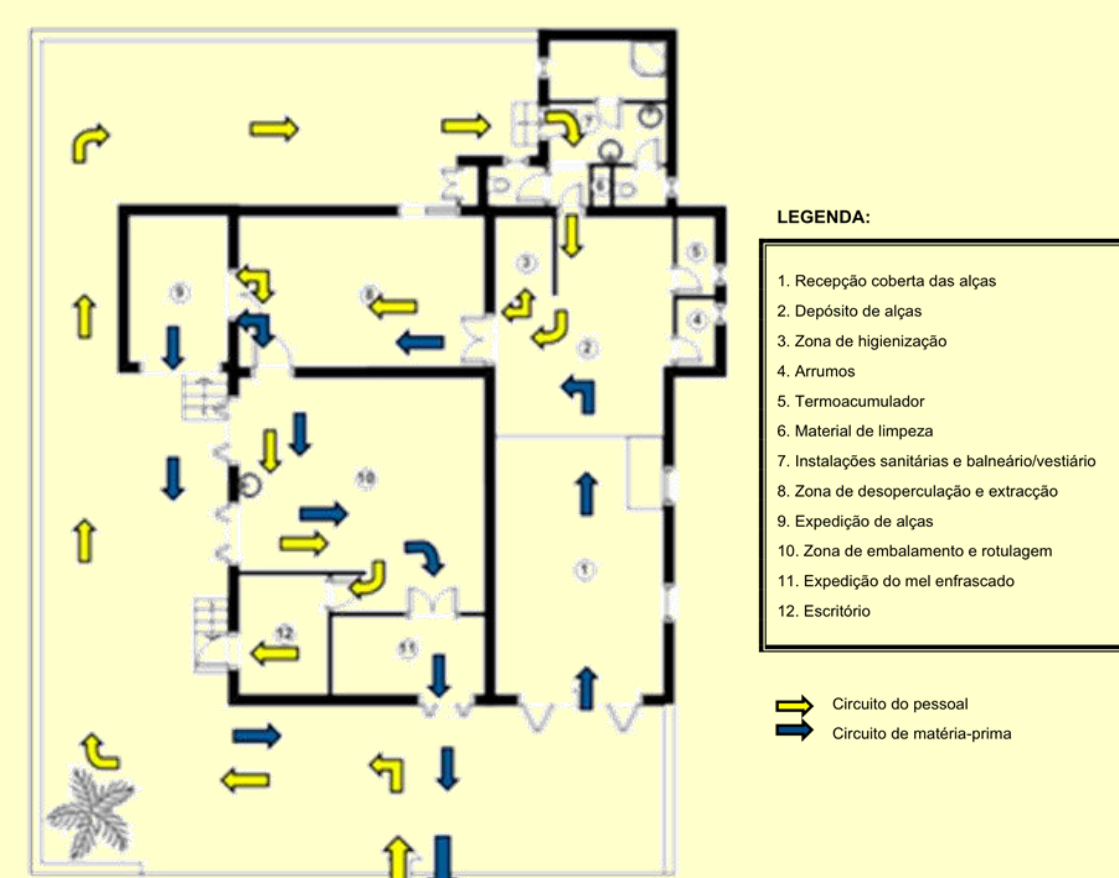
LAYOUT DA MELEIRA COM TODAS AS FASES DE PROCESSAMENTO DO MEL
