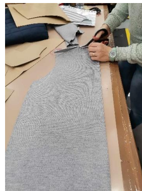
Figura 115 - Confirmação e ajuste da peça em relação aos moldes (Fonte própria)
