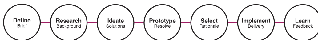
Figura 7 – Processo de Design de Gavin Ambrose e Paul Harris. Fonte: Ambrose & Harris, (2010)
