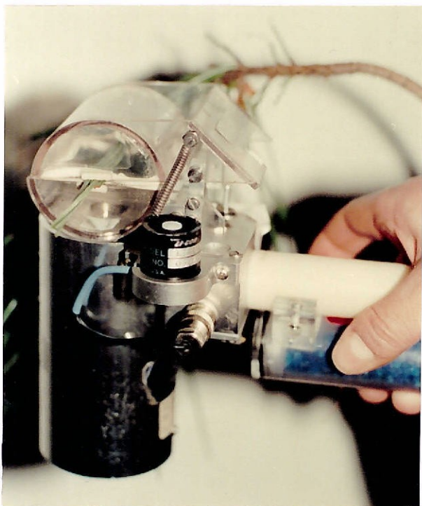
Fig. 4.4 - Porómetro equipado com uma câmara cilíndrica para a realização de medições de condutância estomática em agulhas de pinheiro
