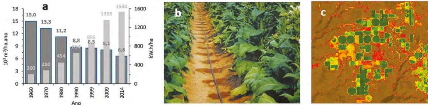
Figura 2 - Evolução do consumo de água e de energia no território nacional (a) (DGADR, 2016), sistema de rega gota-a-gota numa cultura anual (b), e mapa com o índice NDVI com base em imagens do satélite LandSat, pondo em evidência as áreas de regadio, e diferentes estados de stress hídrico (c) (ESRI, 2018).
