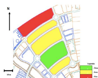
Figura 4. Representação e caracterização das secções quanto à distribuição de contentores de lixo.
