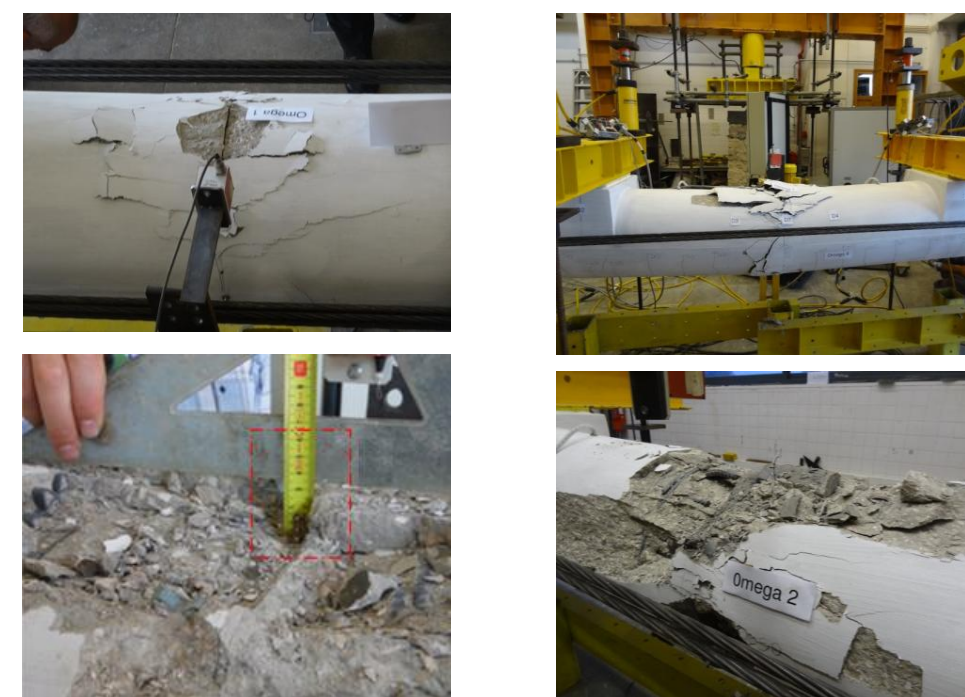
Figura 2. Aspeto do modelo S3 na rutura (à esquerda); Aspeto do modelo S4 na rutura (à direita)
