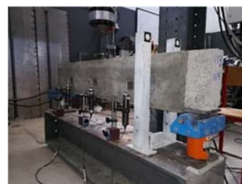
Figura 2. Ensaio de uma viga com superskin e instrumentação.
