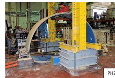
Figura 1 – Ensaio de flexão do provete PH2 (à esquerda) e curva força vs. deslocamento dos provetes PH2 e PH3 (à direita)
