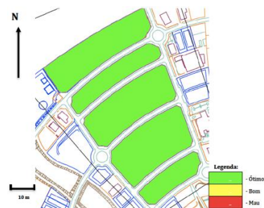
Figura 3. Representação e caracterização das secções quanto às bocas de incêndio.
