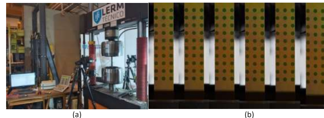
Figura 2. Set-up de ensaio: (a) vista geral; (b) diferentes estádios de ensaio da face do provete avaliada com fotogrametria e DIC.
