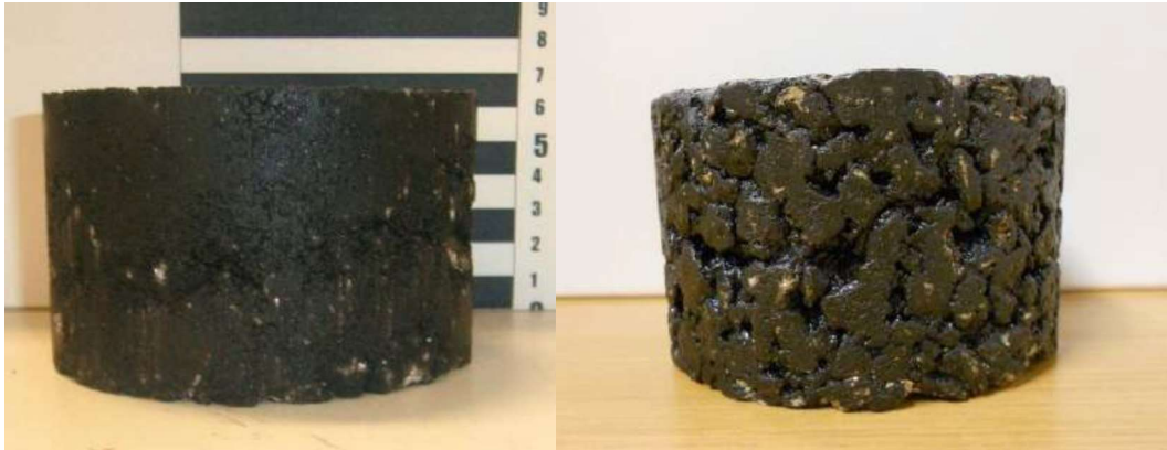
Figura 2: Textura superficial das misturas AC 20 e SMA 12,5 em provetes Marshall
