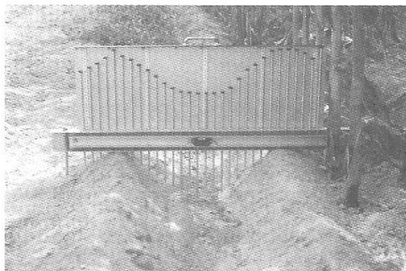
Figura 5. Perfilómetro de agulhas, para registo da secção transversal dos sulcos.
