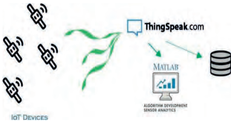
Figura 9.5 - Ilustração do fluxo de comunicação entre os dados enviados pelos dispositivos IoT e o servidor ThingSpeak.
