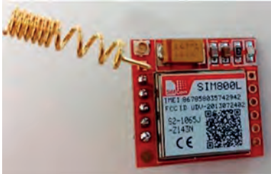
Figura 9.2 - Módulo de comunicação GSM/GPRS SIM800L.
