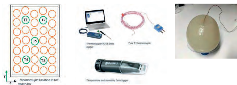
Figura 8.2 - Localização dos termopares na embalagem e dispositivos utilizados na medição da temperatura e humidade relativa.
