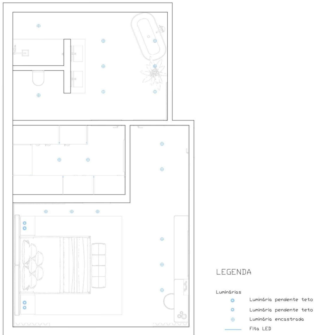
Figura 47 - Desenho técnico, planta de iluminação quarto-suite, projeto KM. Fonte: Beatriz Alves.
