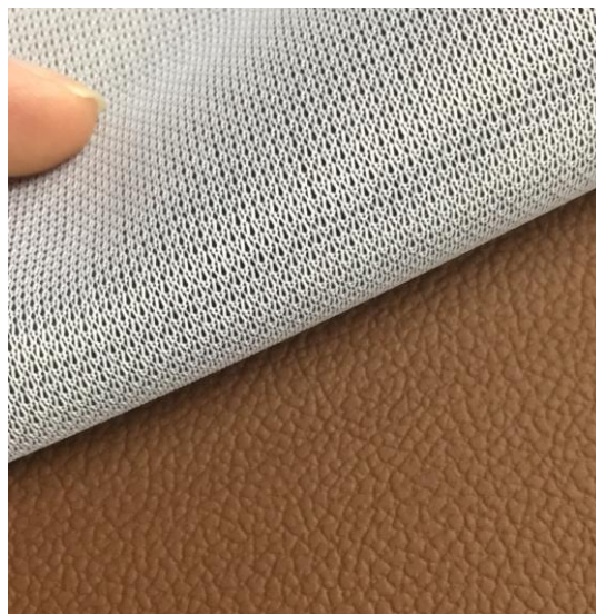
Figura 4 – Exemplo de Couro de PVC acabado. Fonte: BZ LEATHER. Disponível em: https://pt.bzleather.com/pasta/processo-de-fabrica%C3%A7%C3%A3o-de-couro-artificial/ 20:07 18/07/2021.
