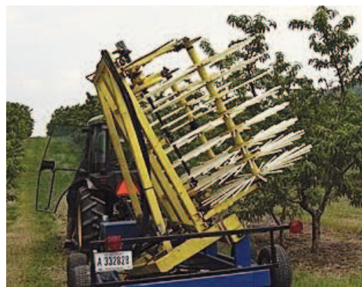
Figura 4: Equipamento mecânico Drum ® utilizado para a monda de flores e frutos. Fonte: retirado de www.goodfruit.com , consultado a 03/01/2016.
