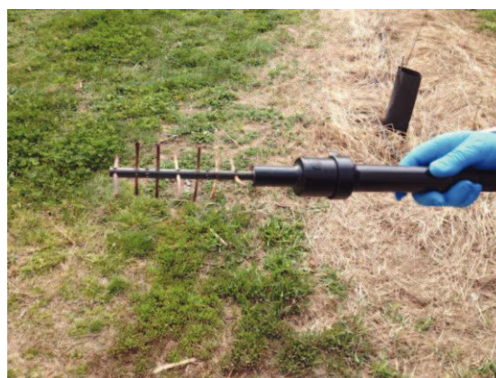
Figura 6: Equipamento mecânico Saflowes Electric ® utilizado para a monda de flores alimentado por bateria. Fonte: Fotografia cedida pelo projeto de investigação +Pêssego.
