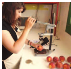
Figura 21: Avaliação da dureza dos frutos com penetrómetro de bancada.
