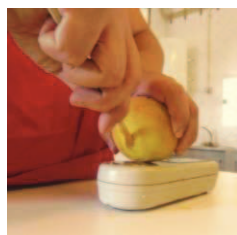
Figura 22: Avaliação dos TSS com refratómetro digital.
