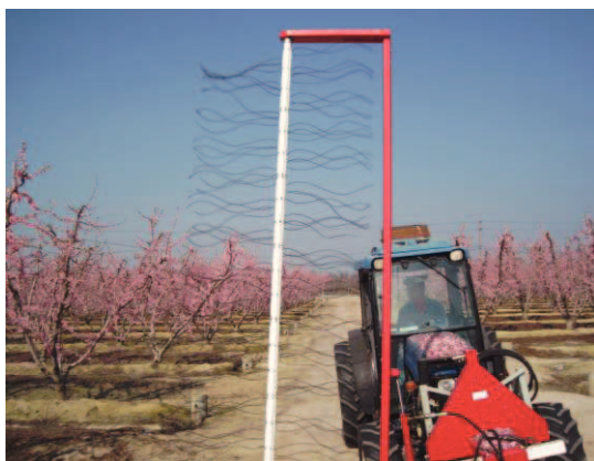
Figura 3: Equipamento mecânico Darwin String Thinner ® utilizado para a monda de flores. Fonte: retirado de http://ucanr.edu , consultado a 03/01/2016.
