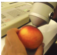
Figura 20: Avaliação da cor dos frutos com colorímetro de Minolta.
