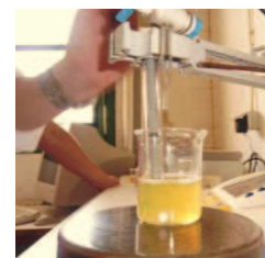
Figura 23: Avaliação da acidez por titulação com NaOH 0,1N.
