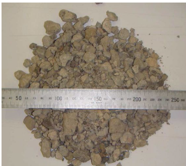
Figura 38 - Agregado de resíduo de betão esmagado (CC3), (20 mm), centro de reciclagem Alex Fraser em Laverton (Aatheesan, 2011)
