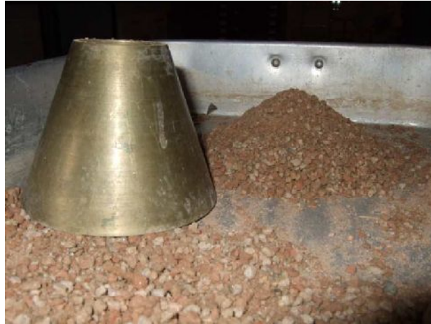
Figura 18 - Agregado de fração granulométrica 0,063 mm a 4 mm saturado com superfície seca, colapso quase total mas com cume bem definido e superfícies planas
