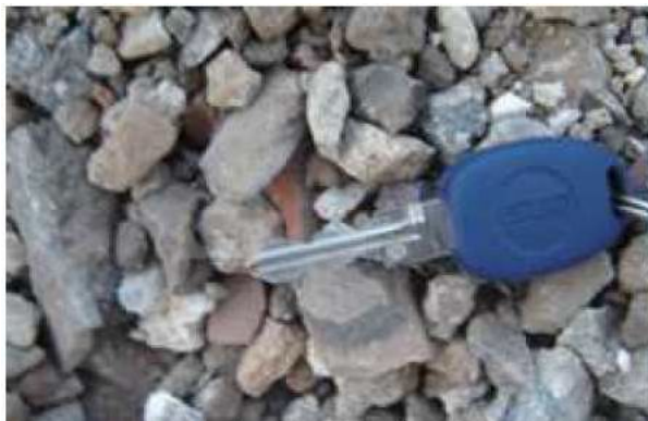
Figura 32 - Agregados RCD misto (Lima, 2008)
