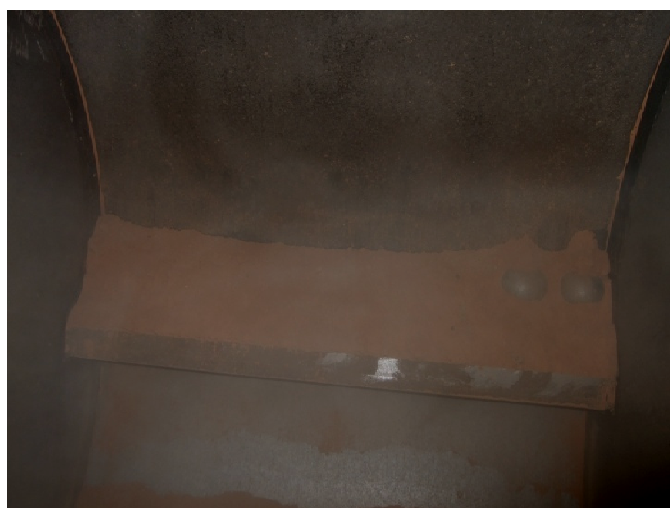
Figura 20 - Interior do tambor da máquina de Los Angeles com o provete e esferas
