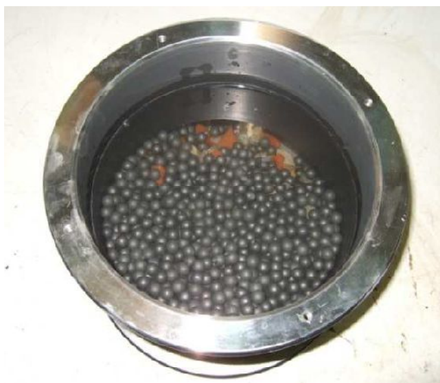
Figura 26 - Agregado com as esferas e água
