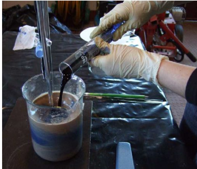
Figura 15 - Adição inicial ao preparado, da solução de azul de metileno adsorvida pela caulinite
