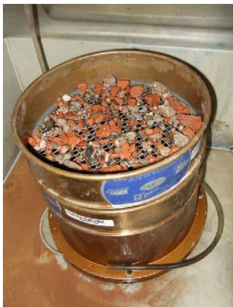
Figura 8 - Lavagem do provete de ensaio
