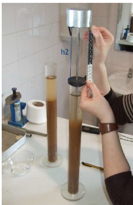
Figura 13 - Altura de sedimentação ( h_2 )
