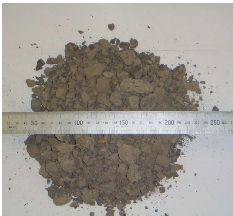
Figura 39 - Agregado de resíduo de pedra basáltica britada (Classe 3), (20 mm), centro de reciclagem Alex Fraser em Laverton (Aatheesan, 2011)
