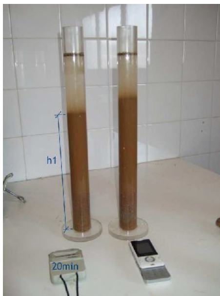
Figura 12 - Distância entre a altura da camada superior do floculado até à base da proveta cilíndrica ( h_1 )
