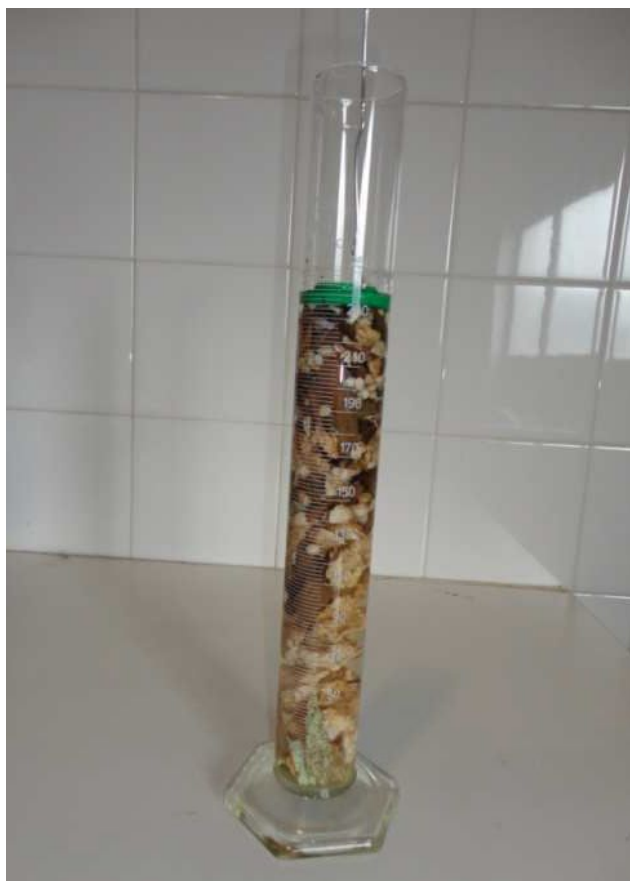
Figura 7 - Determinação do volume das partículas flutuantes, V_{FL}
