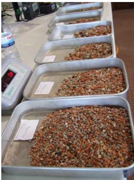
Figura 9 - Separação para pesagem do material retido em cada peneiro - Fração grossa
