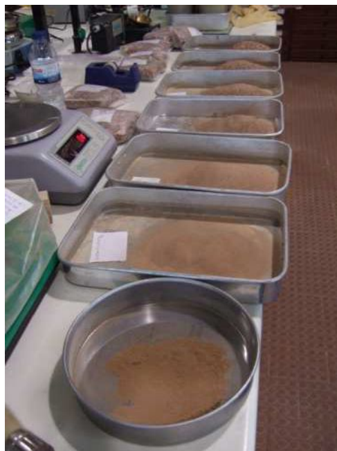
Figura 10- Separação para pesagem do material retido em cada peneiro - Fração fina
