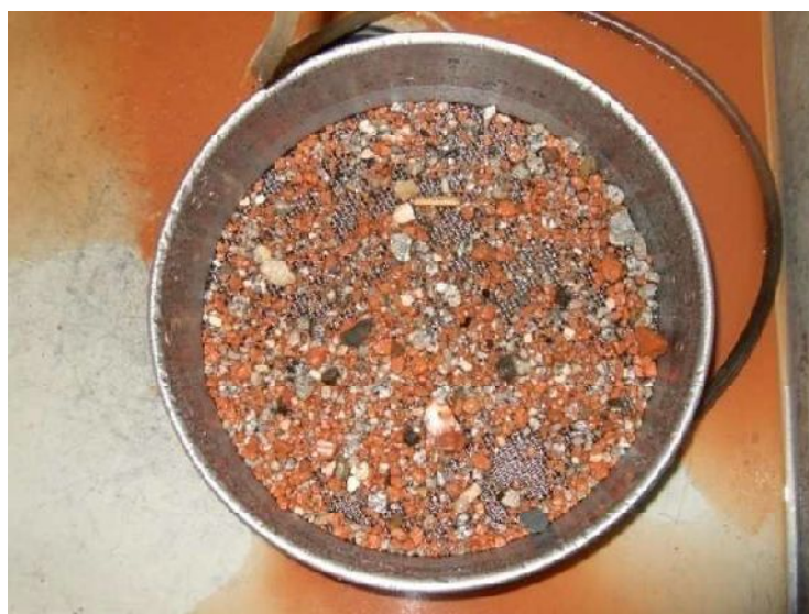
Figura 22 - Lavagem do provete que passa pelo peneiro de #1,6 mm depois da conclusão do ensaio de Los Angeles
