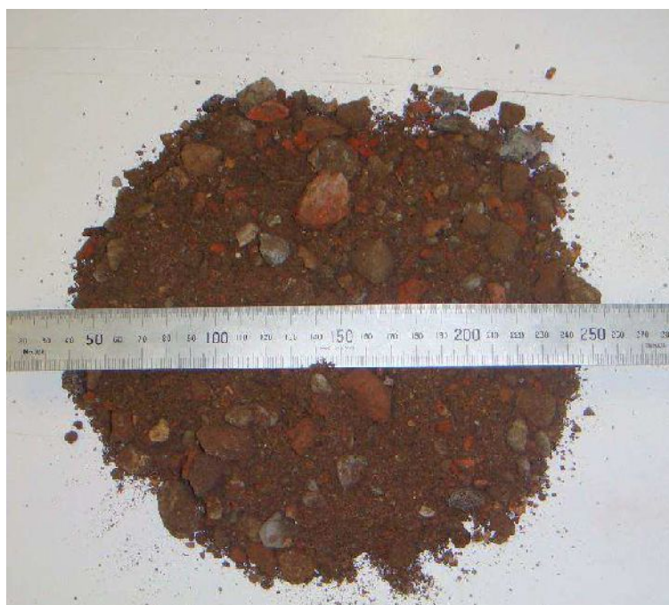
Figura 37 - Agregados de resíduo de tijolo moído (20 mm), centro de reciclagem Alex Fraser em Laverton (Aatheesan, 2011)
