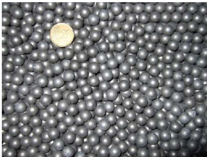
Figura 23 - Esferas - Carga abrasiva
