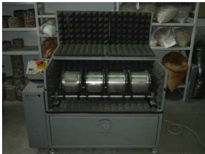
Figura 24 - Máquina do ensaio micro-Deval , com os 4 cilindros rotativo
