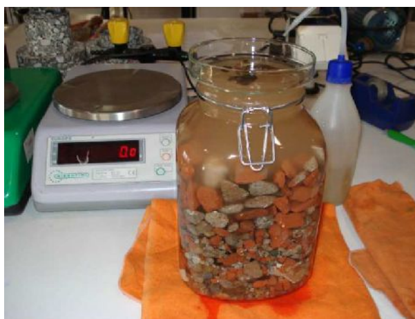
Figura 16 - Picnómetro com o agregado de fração granulométrica 4 mm a 20 mm, cheio de água e sem ar ( M_2 )
