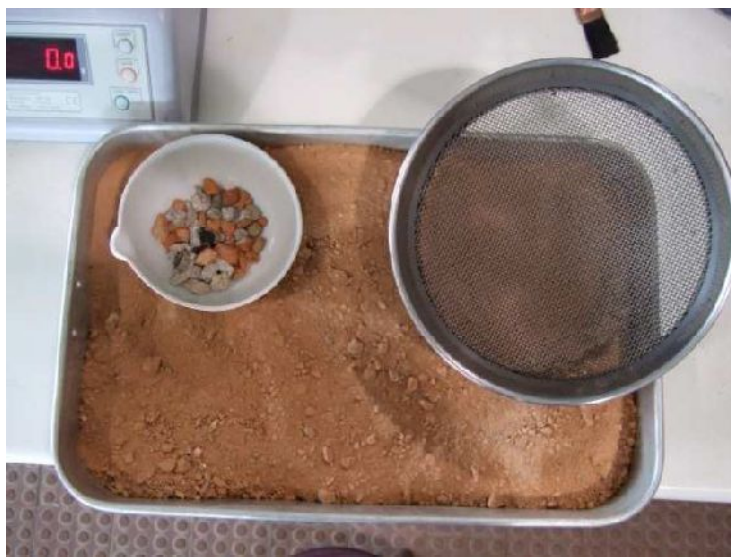
Figura 21 - Agregado antes e depois das 500 voltas na máquina de Los Angeles
