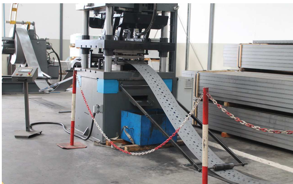
Figura 13. Processo de moldagem a frio - perfiladora
