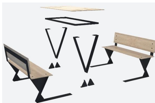
Figura 20 - Visualização 3D dos elementos do equipamento.
