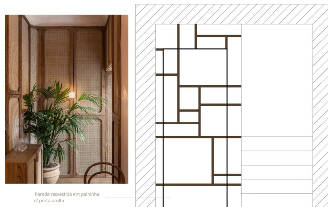
Figura 123 - Corte ilustrativo da parede a lado das escadas. Fonte: Débora Pina
