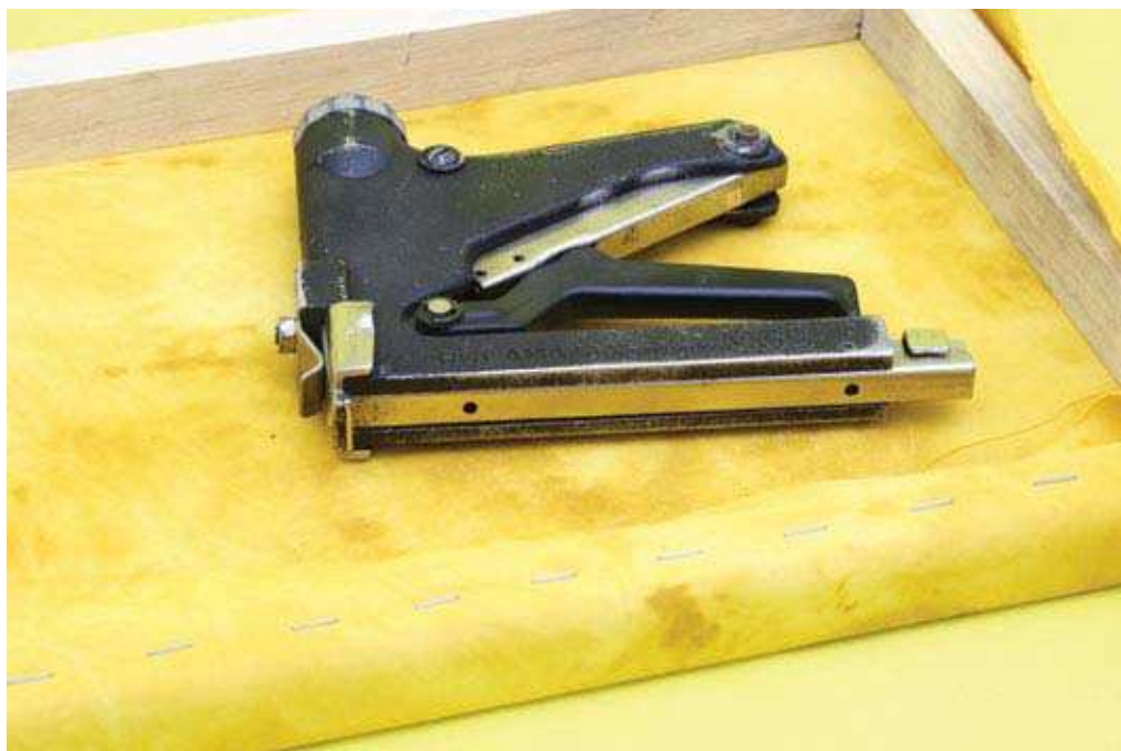
FIG.70- Inserção da rede serigráfica no quadro em madeira com o auxílio de agrafos
