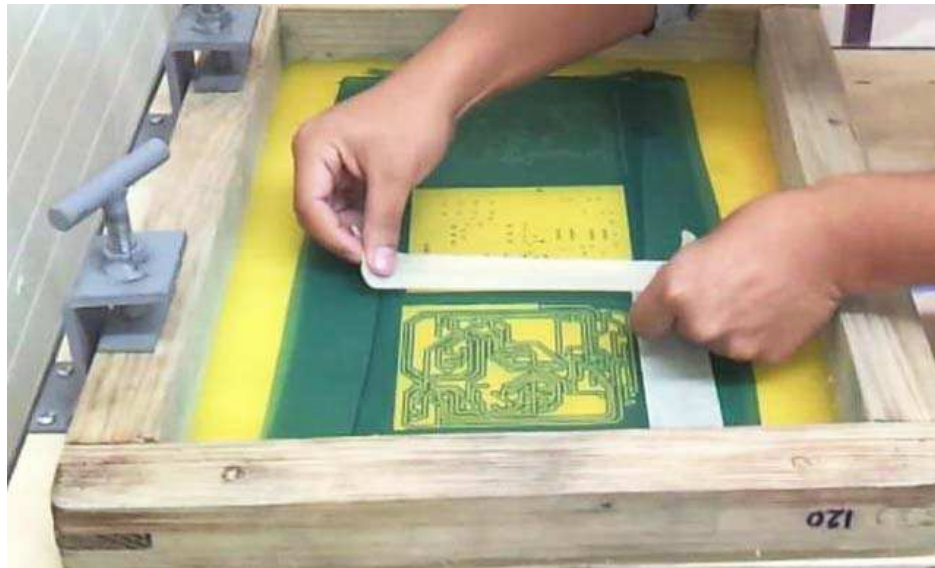
FIG.83- Criação da margem de rede com fita-cola
