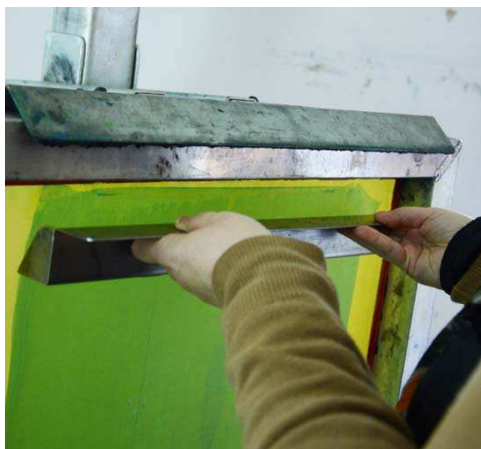
FIG.80- Colocação de emulsão sobre os dois lados da rede
