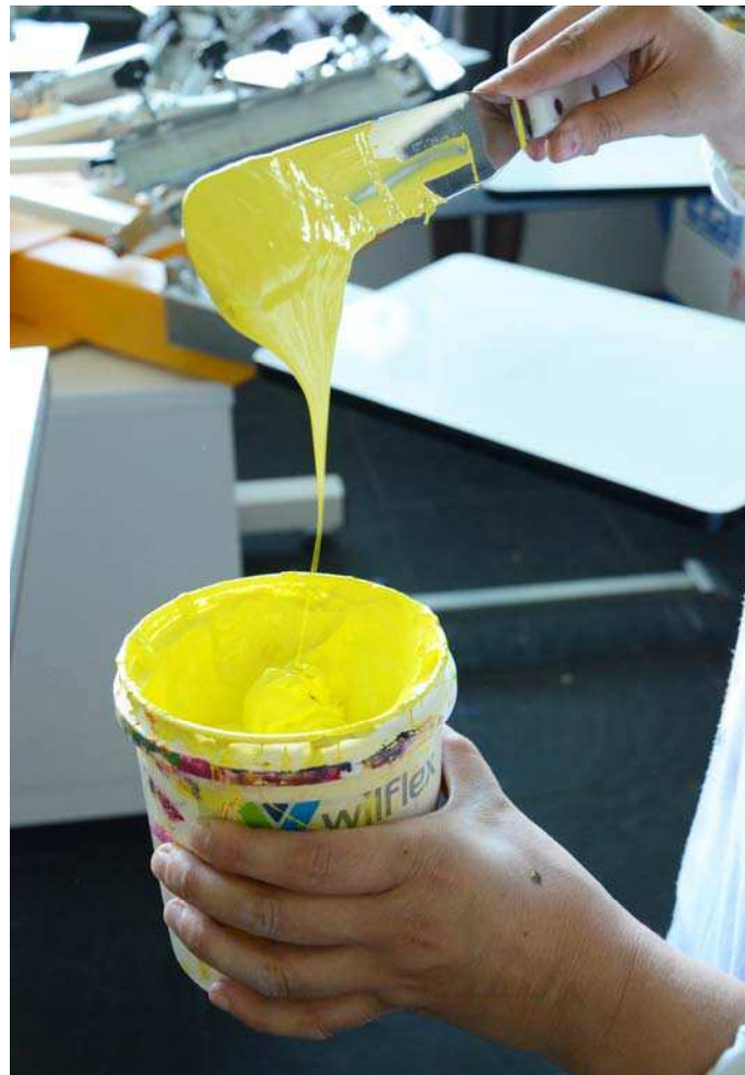
FIG.84- Verificação do estado da tinta
