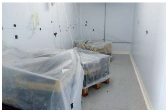
Figura 5.5 – Europaletes cobertas com um saco de LDPE cada uma delas contendo uma modalidade conservada em atmosfera controlada.
