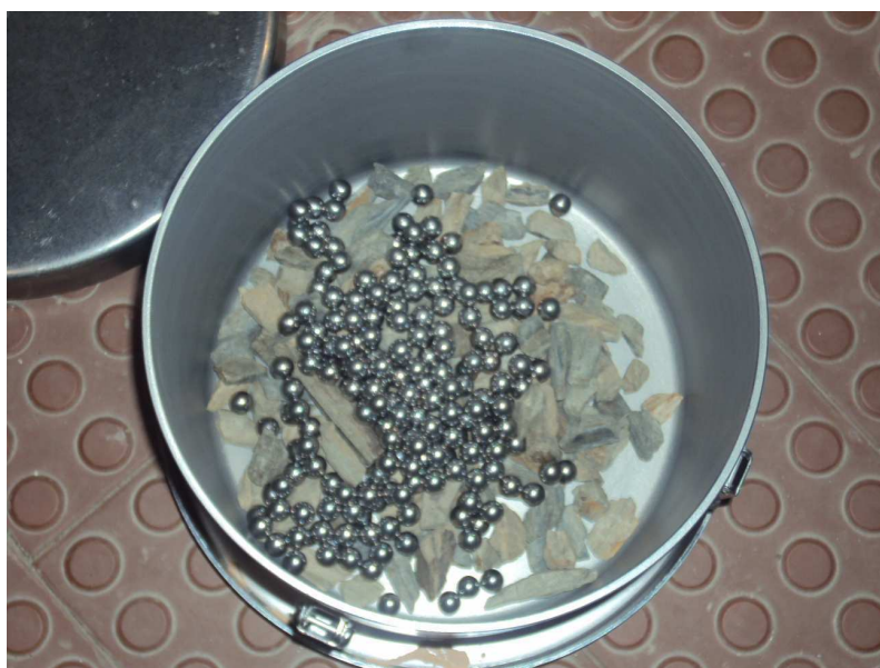
Figura 4.6 - Provete e esferas no cilindro de ensaio
