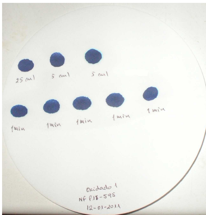
Figura 4.3 - Gotas de preparação no papel de filtro, teste da mancha (AFNOR, 1990)
