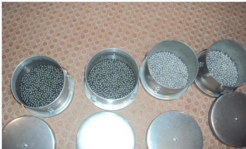
Figura 4.7 - Provetes com carga abrasiva nos cilindros para ensaio
