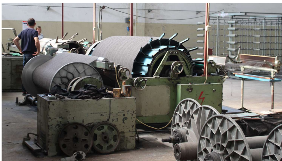
Figura 28: Transferência do urdume [Fonte: Autora, 2022]
