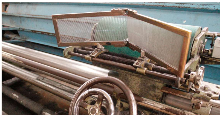
Figura 24: Pente condensador da urdideira [Fonte: Autora, 2023]
