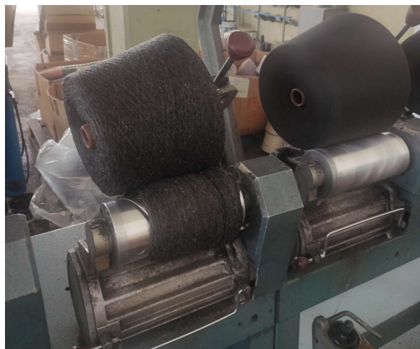
Figura 30: Exemplo de sobreaquecimento da máquina, resultante em desperdício de fio [Fonte: Autora, 2022]
