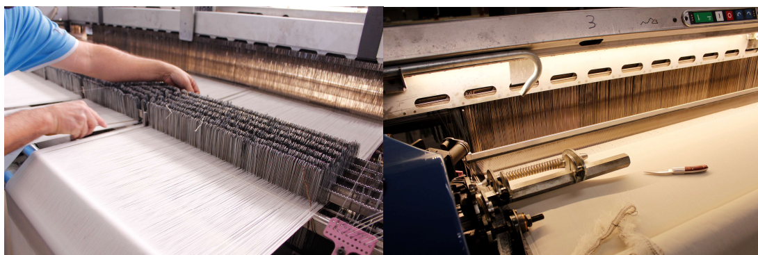
Figura 33: Tecelagem da trama [Fonte: Autora, 2022]
