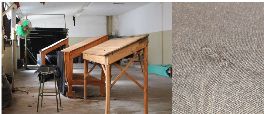
Figura 36: Revista e correção de defeitos que podem surgir no tecido [Fonte: Autora, 2022]
