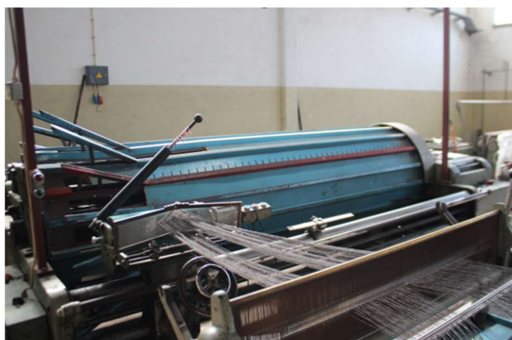
Figura 25: Pente de crus, pente condensador e tambor da urdideira [Fonte: Autora 2022]
