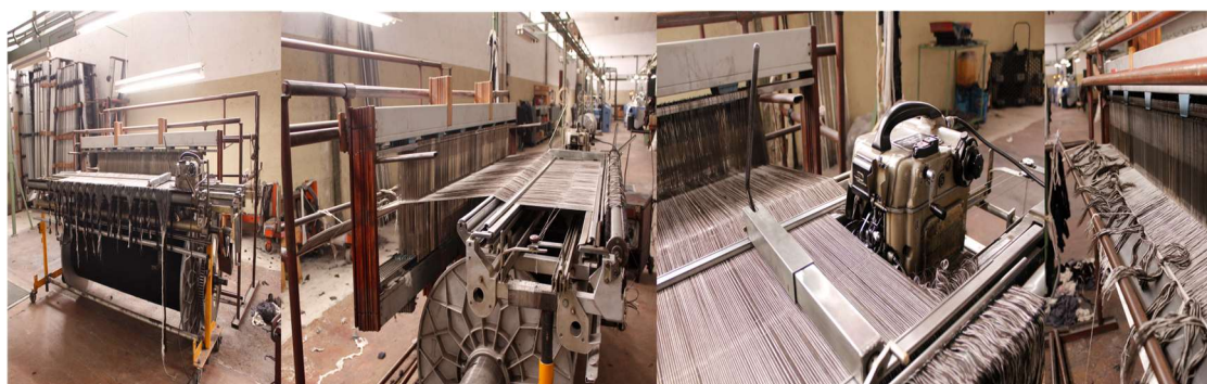
Figura 32: Montagem do órgão no tear [Fonte: Autora, 2022]
